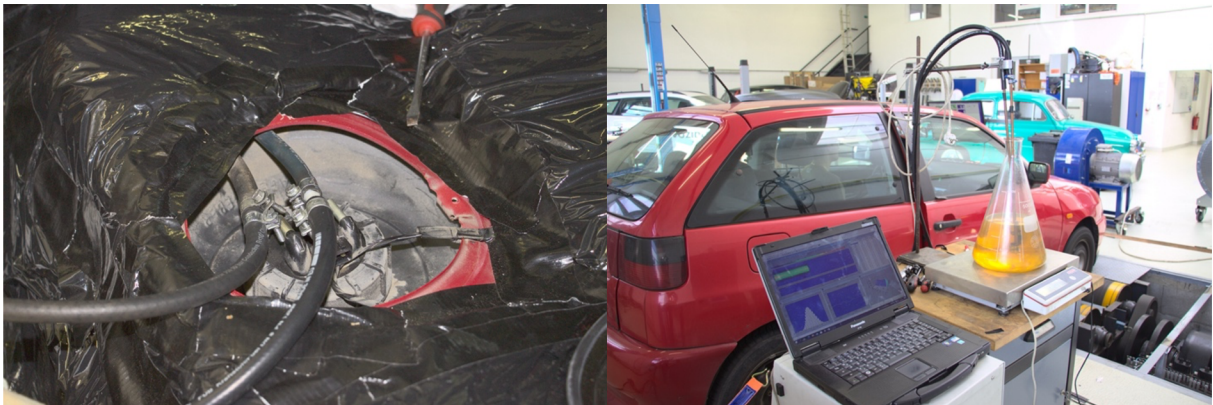
Obrázek č. 19: Detail přepojených hadiček z hrdla víka nádrže v interiéru pro propojení s externí pumpou (vlevo) [autor]. Aparatura se vzorkem paliva Verva v Erlenmeyerově nádobě postavené na váze (vpravo), kde lze vidět i počítač s programem emisního analyzátoru TSI EEPS 3090. [fotil Bc. Jakub Adam]
