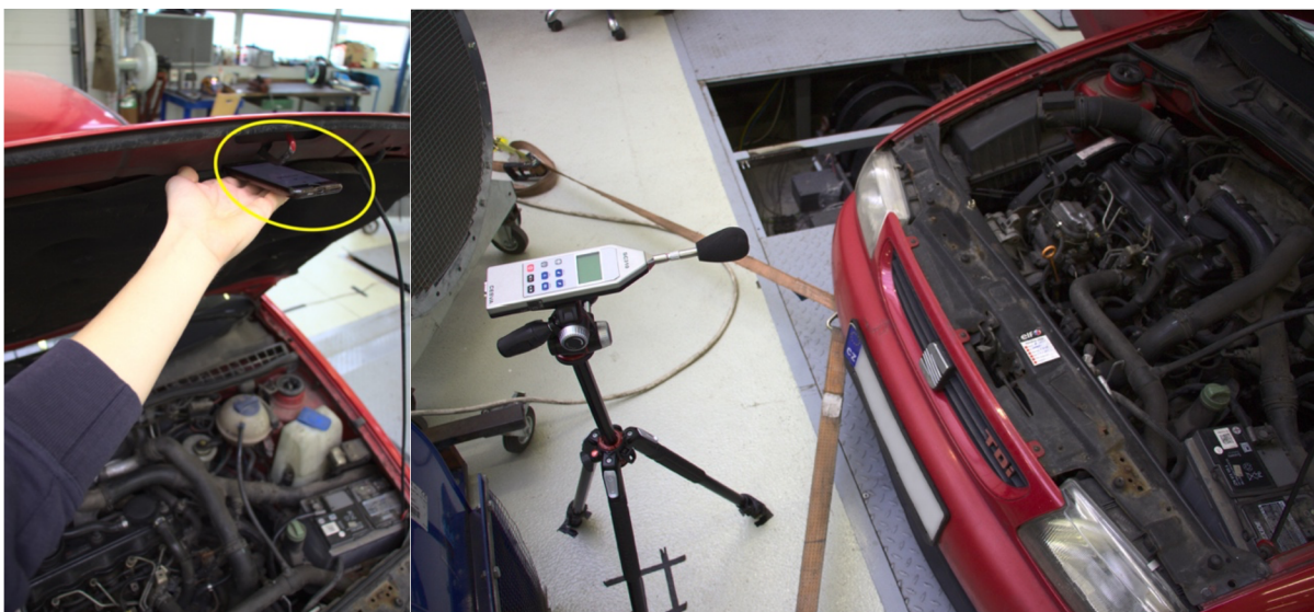
Obrázek č. 21: Pozice smartphonu při měření frekvenčního spektra (vlevo) a pozice hlukoměru (vpravo) [autor]
