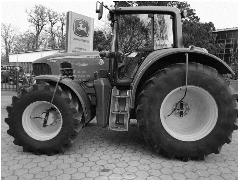
Obr. 6 – Dodatečně instalovaný vnější systém regulace tlaku (Agr21), upraveno
