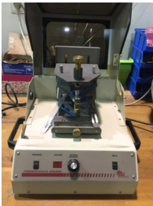
Obr. 3.7 Kondenzátorová svářečka na termočlánky
