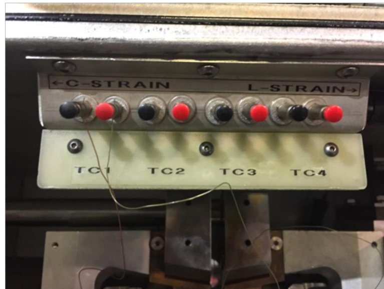
Obr. 3.10 Připevnění drátků do svorkovnice
