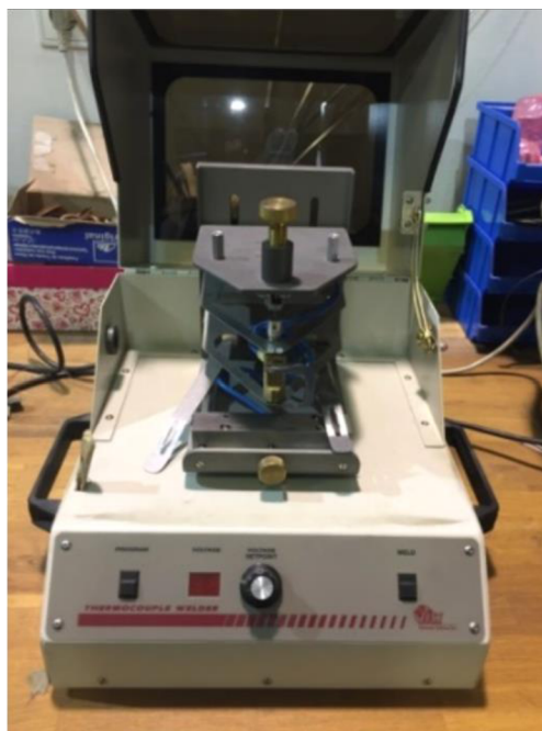
Obr. 3.7 Kondenzátorová svářečka na termočlánky
