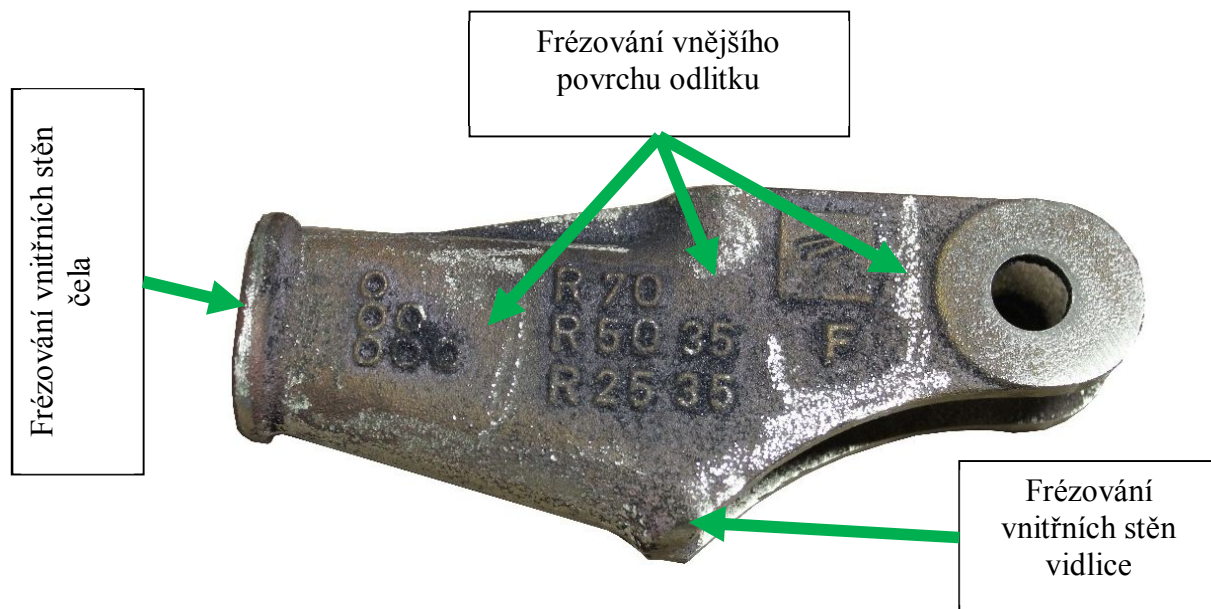
Obr. 53 Oblasti frézování
