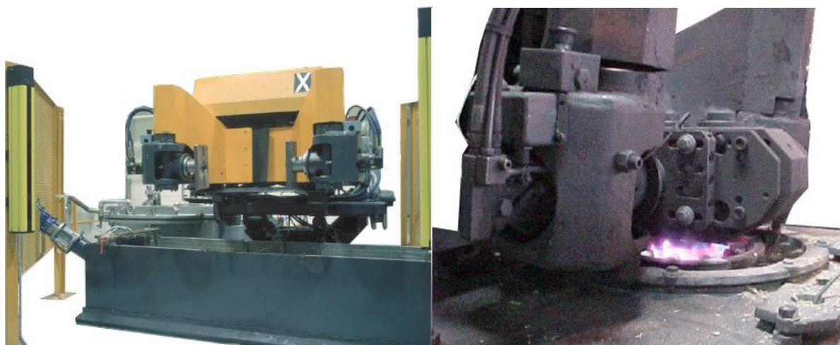
Obr. 12 Nízkotlaké pracoviště pro výrobu odlitků ze slitin mědi [1]
