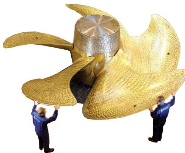
Obr. 22 33 tunový loďní šroub z hliníkové bronzy [24]
