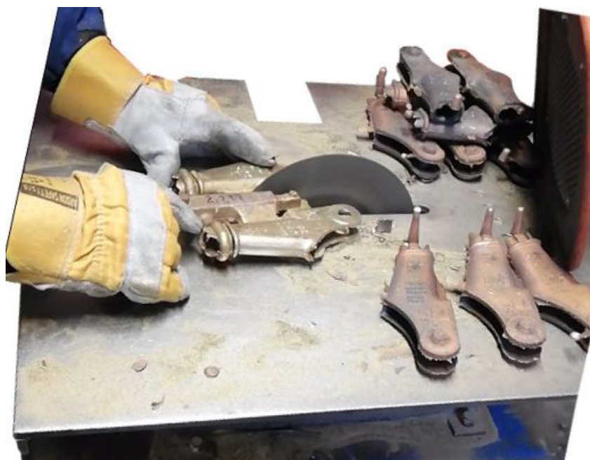
Obr. 49 Ořezávání vtokové soustavy
