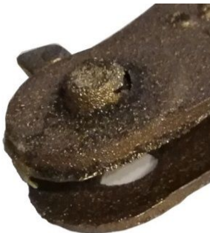
Obr. 50 Připečené ostřívo v odlitku KN10
