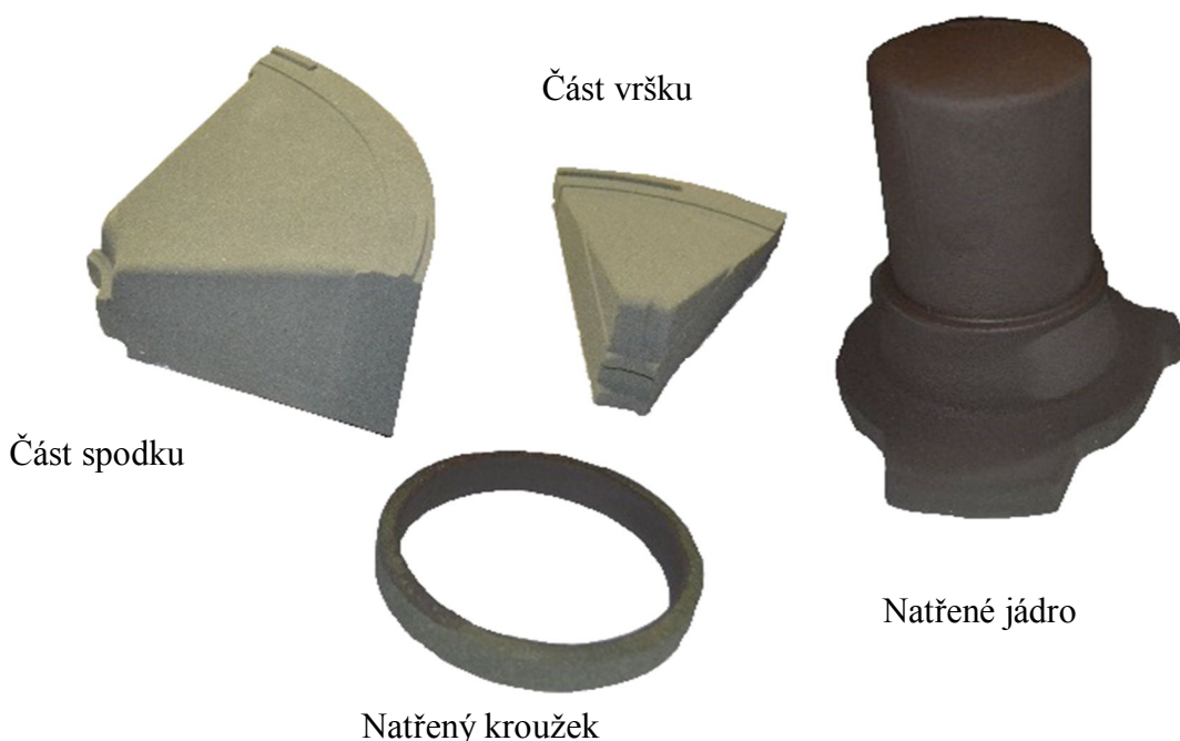
Obr. 2 Jednotlivé díly formy ventilátoru [11]
