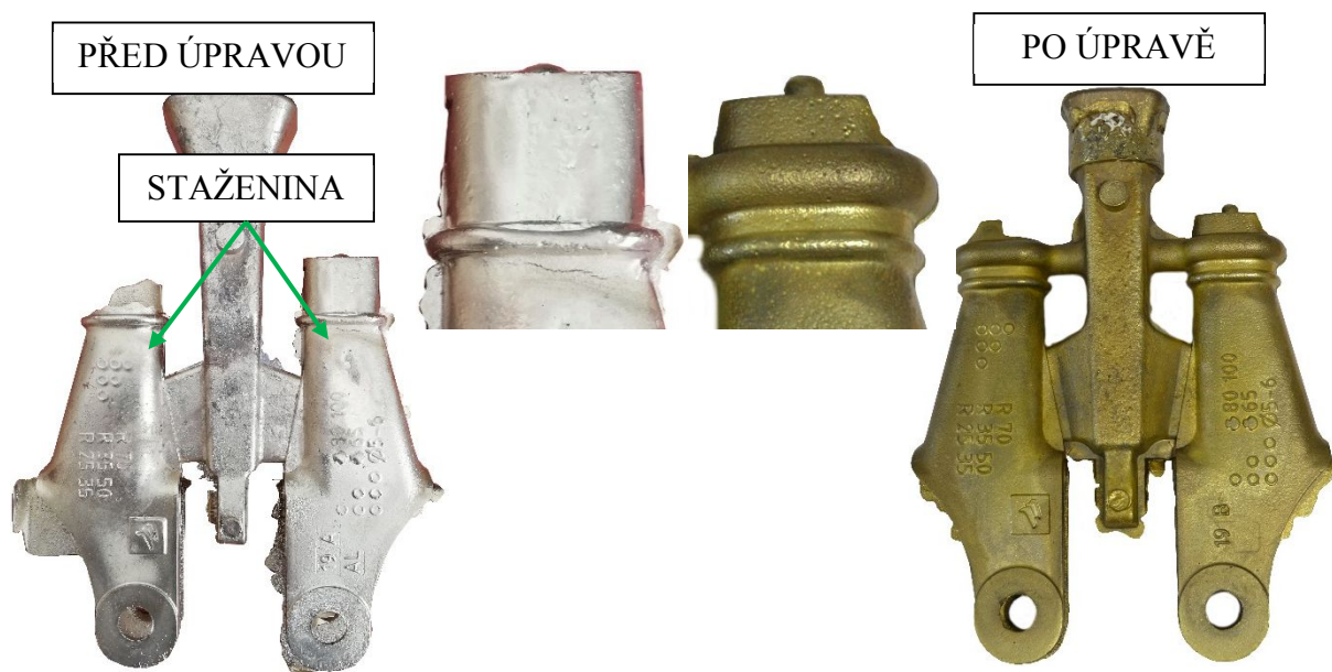
Obr. 64 Výsledek úpravy kovové formy
