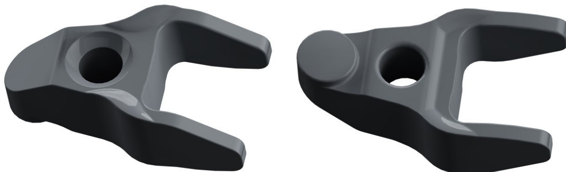
Obr. 43 Model třmenu vstřikovače s nálitky
