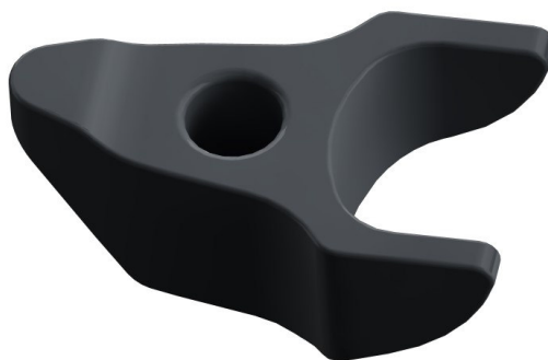
Obr. 58 Model třmenu vstřikovače po první tvarové optimalizaci – pohled zdola
