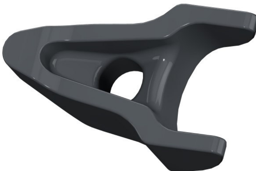
Obr. 71 Model třmenu vstřikovače po třetí tvarové optimalizaci
