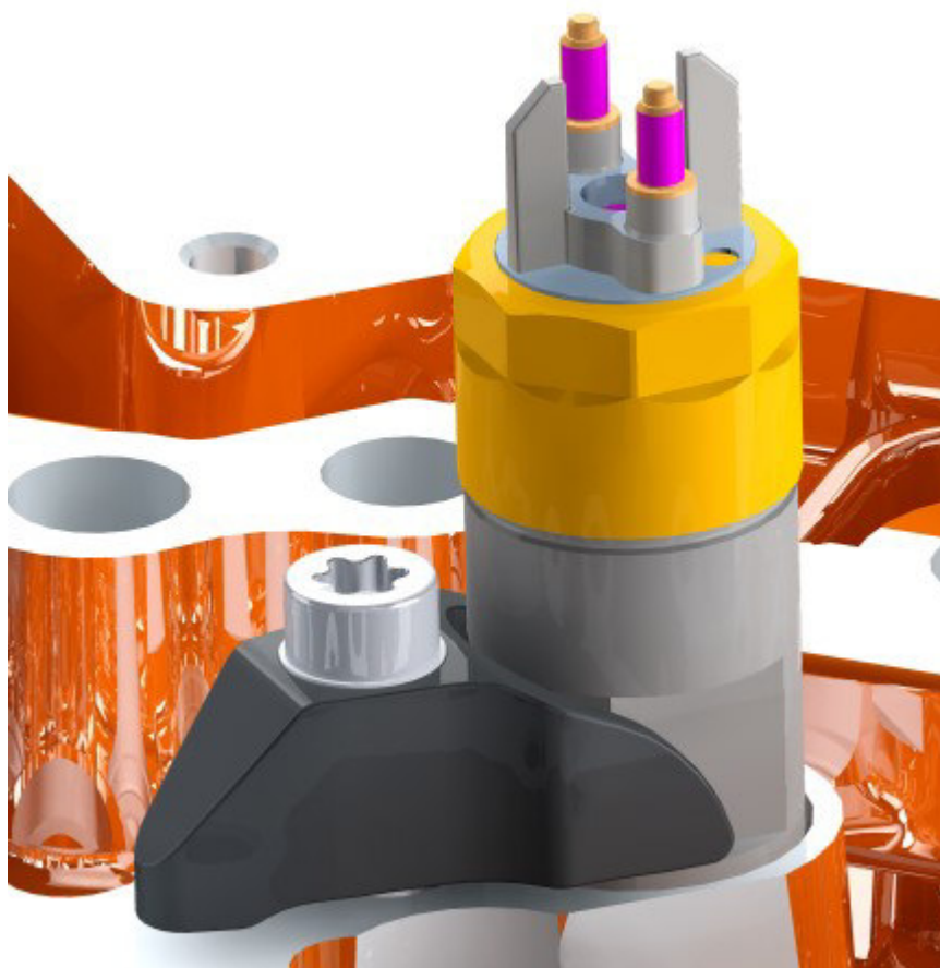
Obr. 75 Sestavný model s navrženým třmenem vstřikovače
