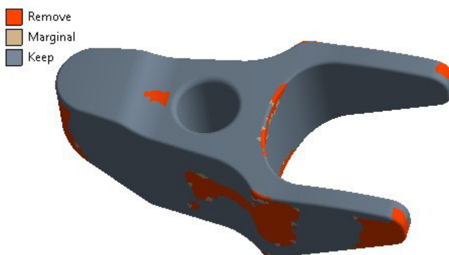
Obr. 55 Výsledek první tvarové optimalizace – pohled zdola
