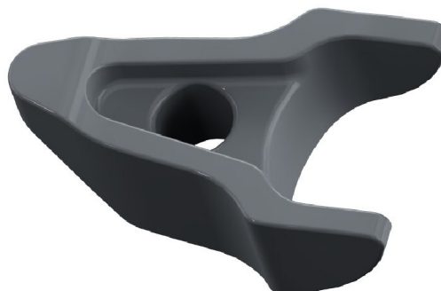
Obr. 66 Model třmenu vstřikovače po druhé tvarové optimalizaci – pohled zdola
