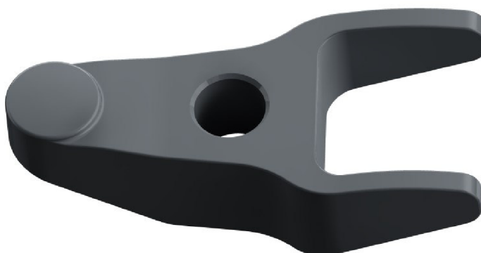
Obr. 37 Model upraveného třmenu vstřikovače – pohled zdola
