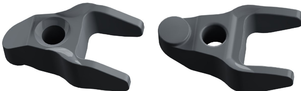
Obr. 43 Model třmenu vstřikovače s nálitky
