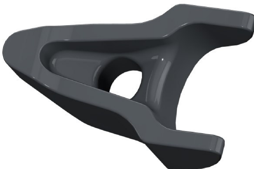
Obr. 71 Model třmenu vstřikovače po třetí tvarové optimalizaci
