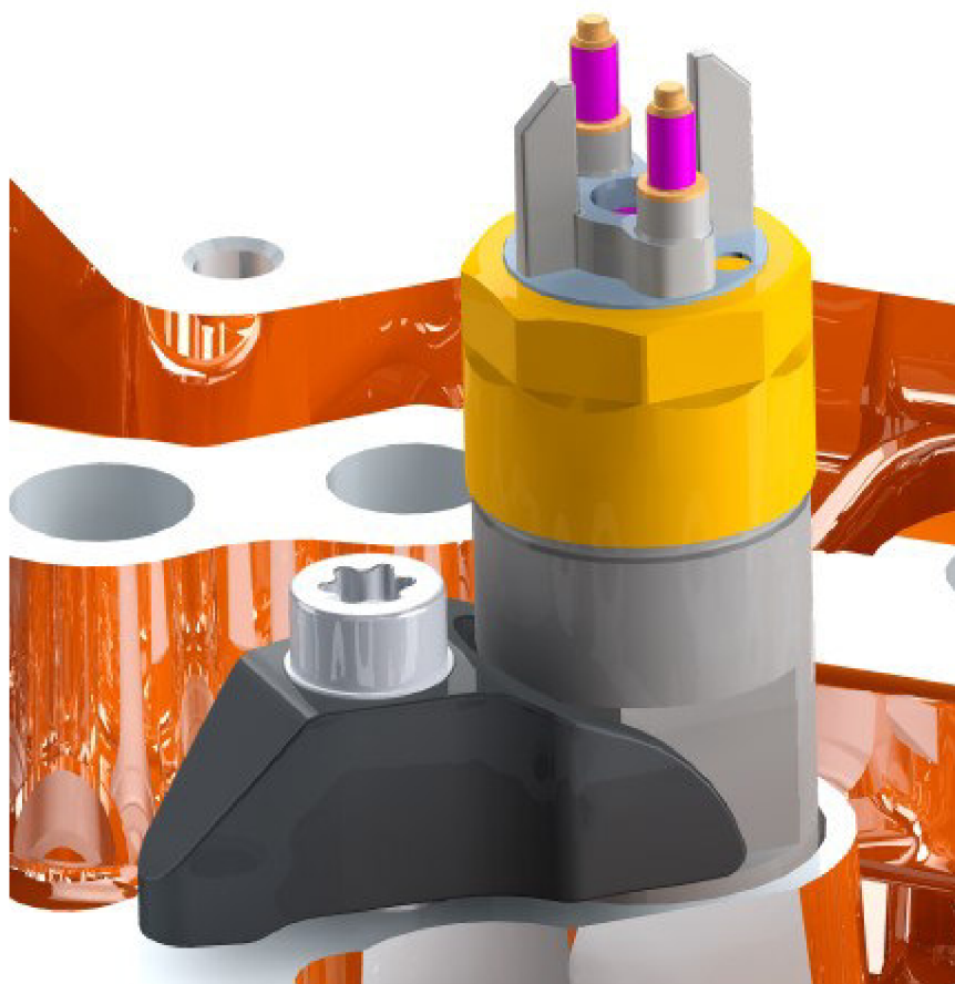
Obr. 75 Sestavný model s navrženým třmenem vstřikovače
