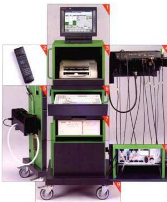
Obrázek 12 Bosch ESA, 1 - Monitor, 2 - Dálkové ovládání, 3 - Inkoustová tiskárna, 4 - Měřící modul MTM Plus, 5 - Modul opacimetru RTM 430, 6 - Klávesnice, 7 - PC Modul, 8 - Modul analyzátoru ETT 8.70-1, 9 - Dílenský vozík (MENDELOVA UNIVERZITA V BRNĚ)
