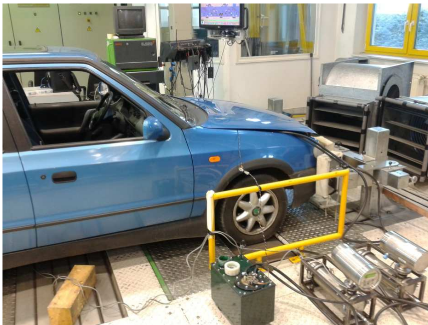
Obrázek 21 Instalace ventilátorů pro chlazení motoru
