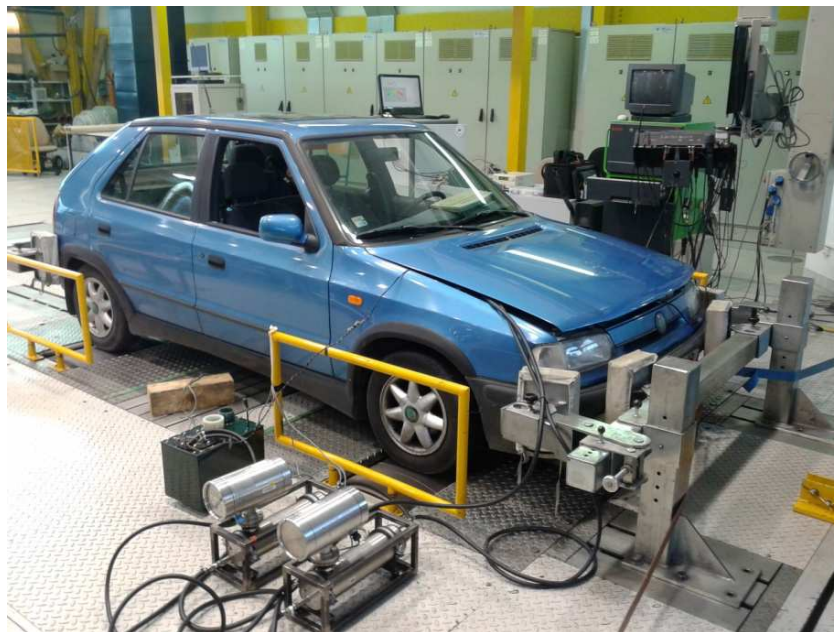
Obrázek 19 Přední ukotvení měřeného vozidla
