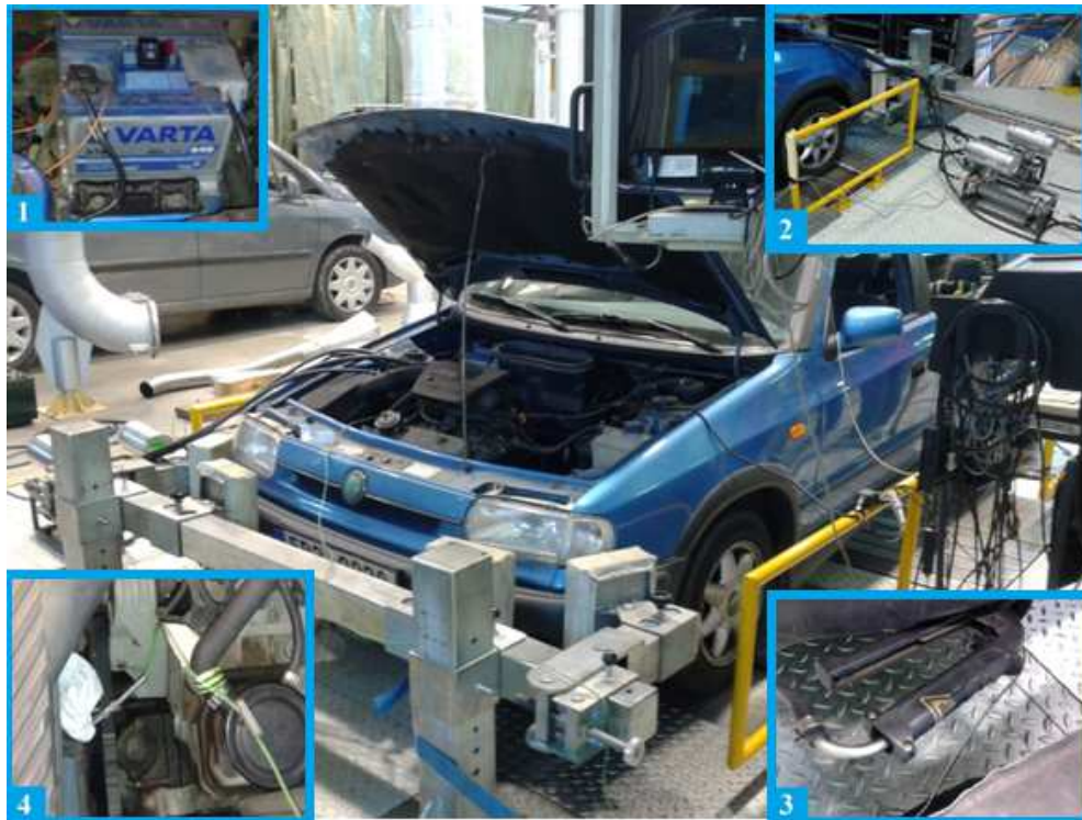
Obrázek 22 Připojení měřících zařízení a snímačů k měřenému vozidlu: 1 - připojení vypínače a vodičů pro přívod el. energie k externí palivové nádrži, 2 - připojení Coriolisových průtokoměrů, 3 - vložení analyzátoru výfukových plynů do výfukového potrubí, 4 - umístění snímače teploty nasávaného vzduchu
