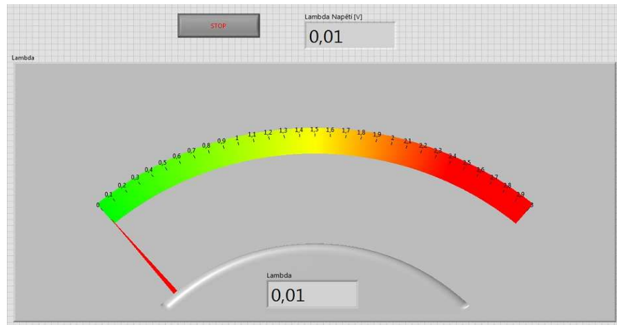
Obrázek 17 Uživatelské prostředí vytvořené v programu LabVIEW 2013 pro měření hodnot \lambda a napětí \lambda
