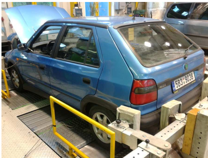
Obrázek 20 Zadní ukotvení měřeného vozidla
