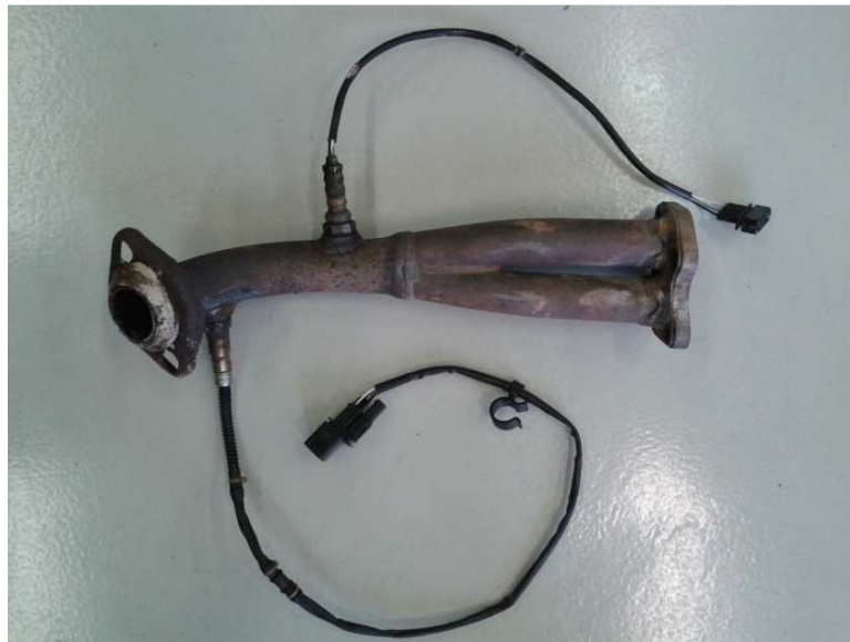
Obrázek 14 Upravený díl výfukového potrubí s originální dvoustavovou a přídatnou širokopásmovou lambda sondou
