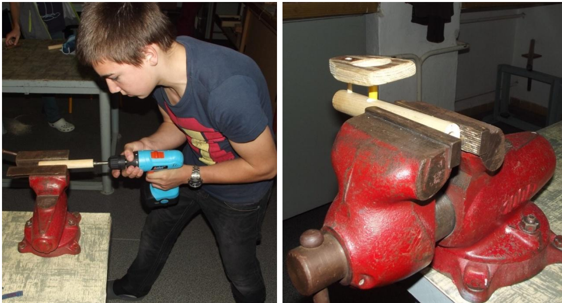
Obr. 63 a 64: Vrtání hlavního vzduchového kanálu a zkompletovaný výrobek.
