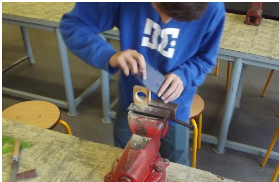
Obr. 62: Dokončování objímky míčku.
