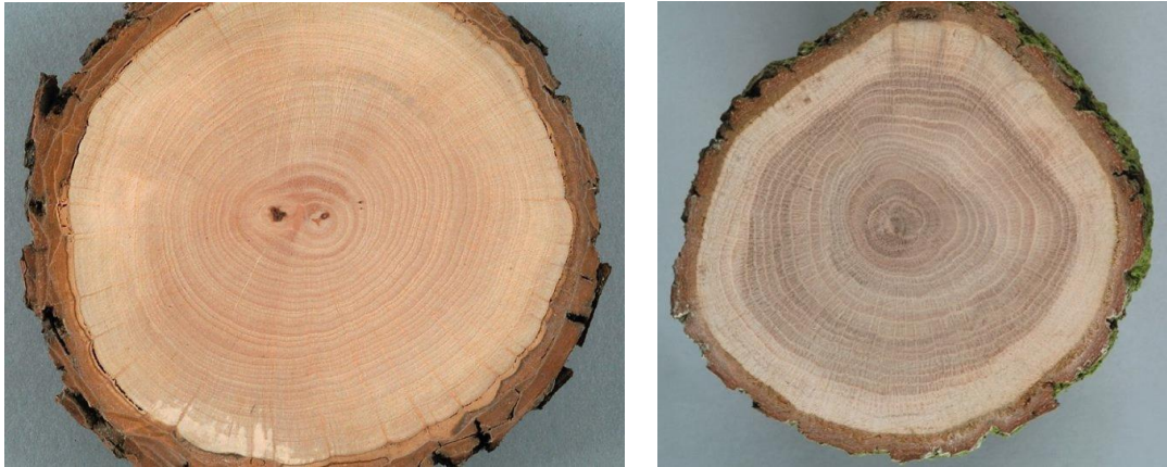
Obr. 1 a 2: Srovnání bělového a jádrového dřeva olše a dubu. [23]
