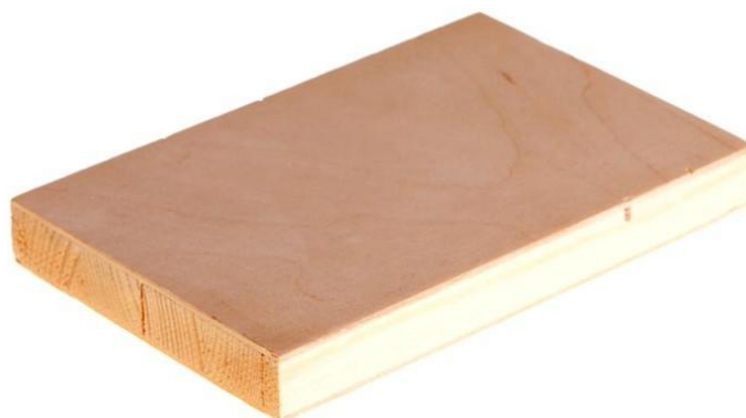
Obr. 8: Laťovka se středem ze smrkových latěk oplášťovaná březovou dýhou. [21]
