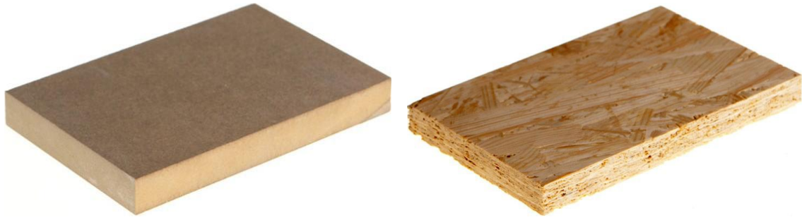
Obr. 9 a 10: Dřevovláknitá deska střední hustoty (MDF) a deska z orientovaných plochých třísek (OSB). [21]
