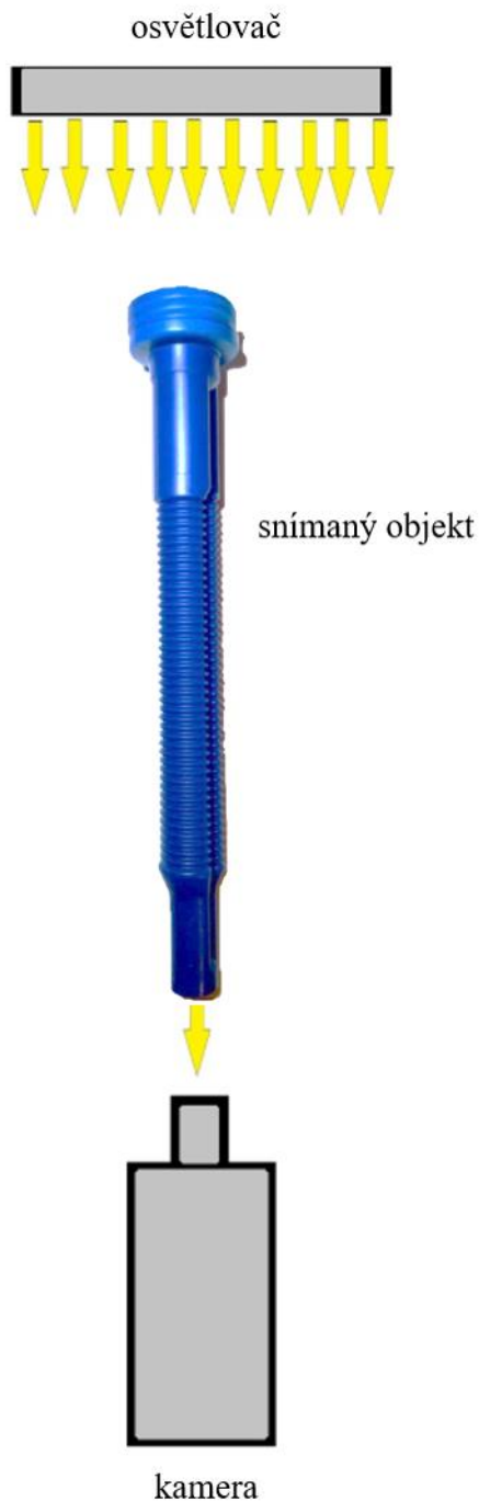
Obr. 10 vlevo – schéma zadního osvětlení, vpravo – získané snímky při použití tohoto uspořádání a) zcela průchozí otvor, b) neprůchozí otvor, c) částečně průchozí otvor
