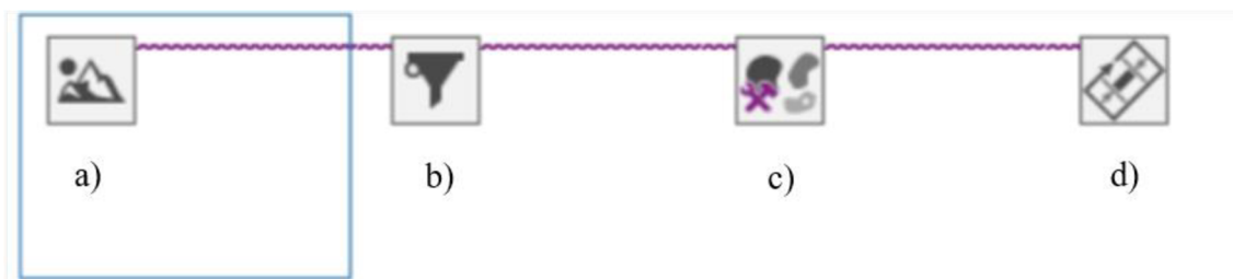
Obr. 22 Algoritmus kontroly přetoku, a) původní snímek, b) filtr, c) monochromatická morfologie, d) analýza obrazu
