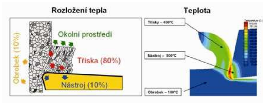
Obr. 1 Teplota a teplo v místě řezu [ 17 ]
