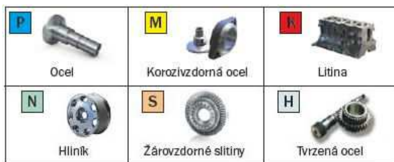
Obr. 11 Skupiny obráběných materiálů dle ISO [18]
