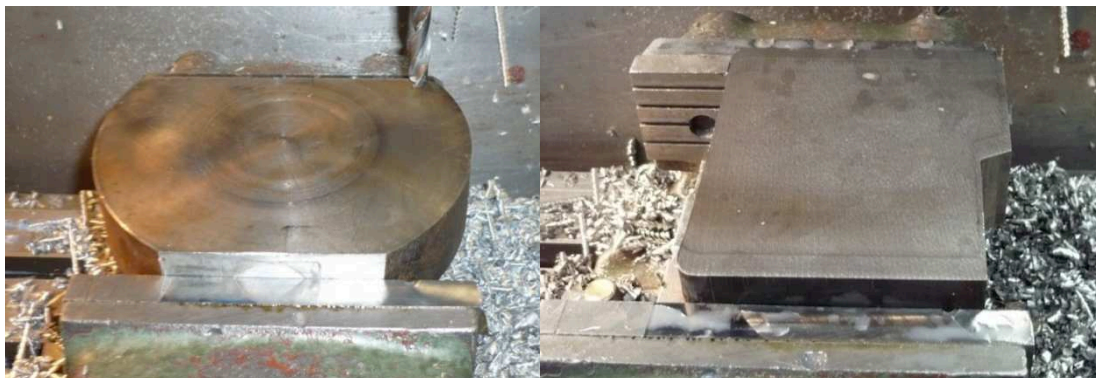
Obr. 27 Připravené vzorky oceli (vlevo) a litiny (vpravo) pro experiment
