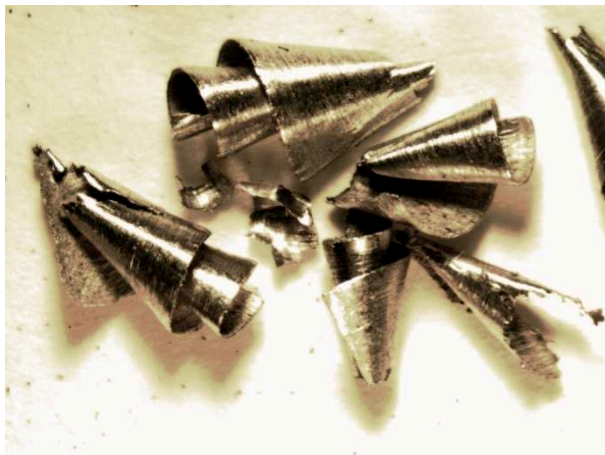
Obr. 41 Tříška vzniklá při vrtání hliníku
