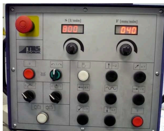
Obr. 32 Ovládací panel s nastavenými řeznými podmínkami
