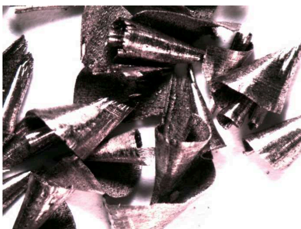
Obr. 40 Tříska vzniklá při vrtání mosazi
