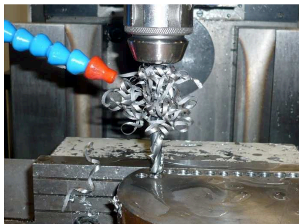
Obr. 44 Tříska vzniklá při vrtání oceli - nevhodná
