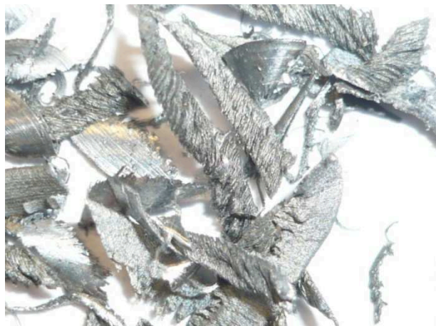
Obr. 43 Tříska vzniklá při vrtání oceli
