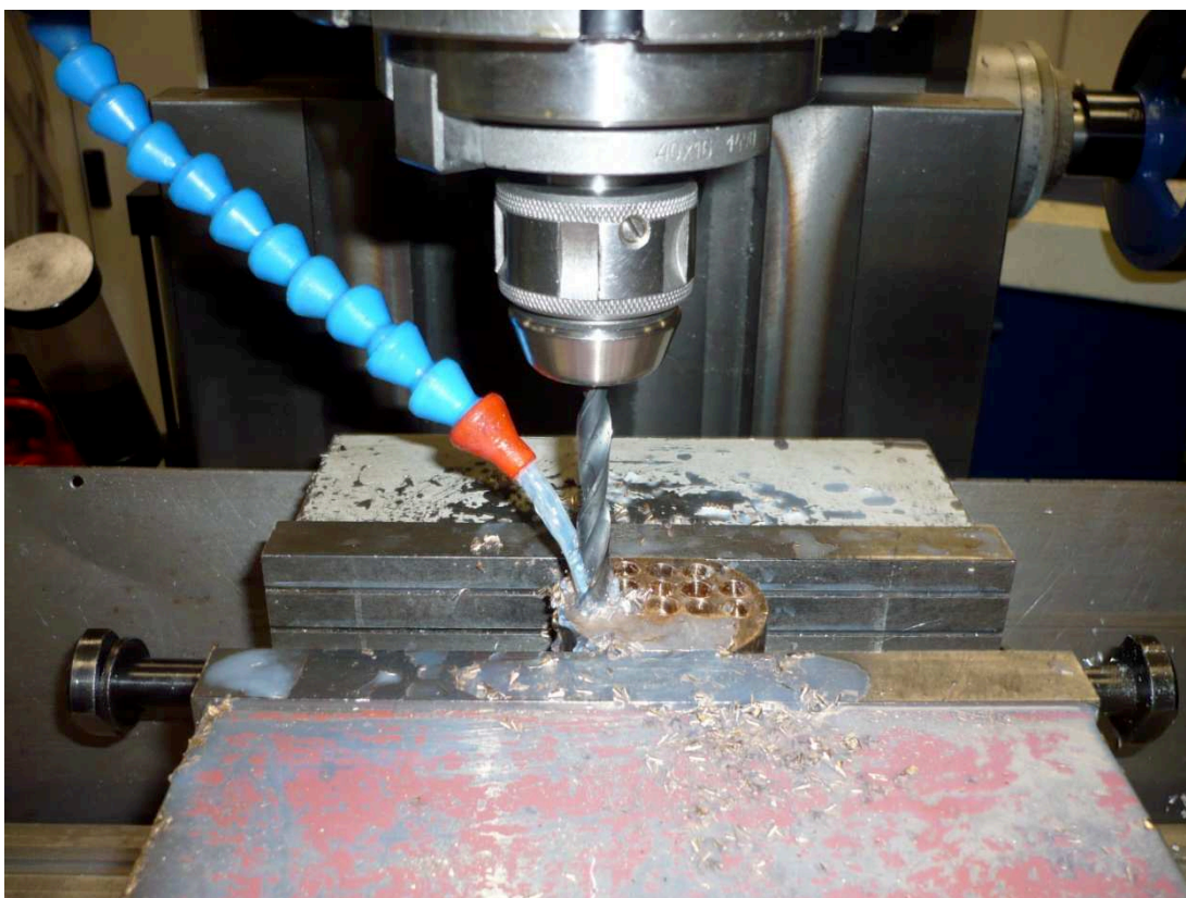
Obr. 34 Proces obrábění mosazi
