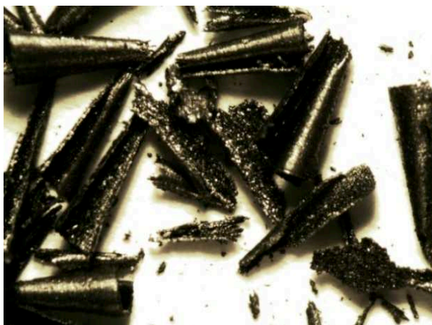
Obr. 42 Tříška vzniklá při vrtání litiny
