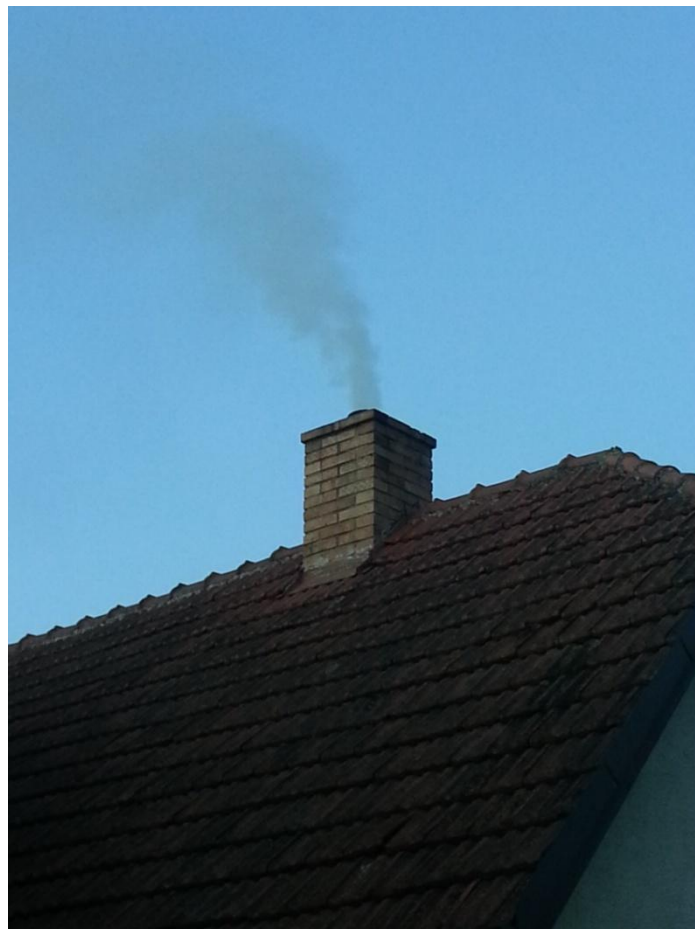
Obrázek č. 4: Tmavost kouřové vlečky 2. stupně Ringelmannovy stupnice.
