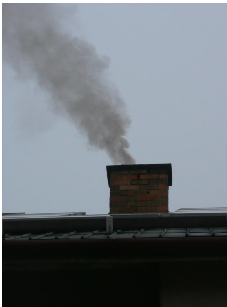
Obrázek č. 6: Tmavost kouřové vlečky 4. stupně Ringelmannovy stupnice.
