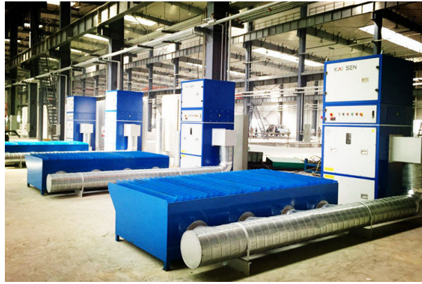
Obrázok 5 Pohľad na inteligentný systém odsávania spalin laserovej rezačky [9]
