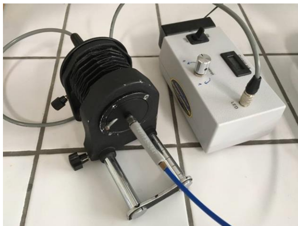
Obrázek 33 Měření spektrální intenzity ozáření UV LED zdrojů
