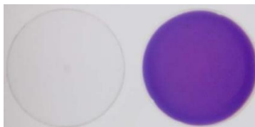
Obrázek 16 Ukázka barevného přechodu dozimetru před a po ozáření 39
