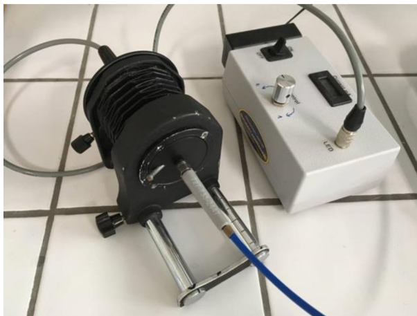
Obrázek 33 Měření spektrální intenzity ozáření UV LED zdrojů
