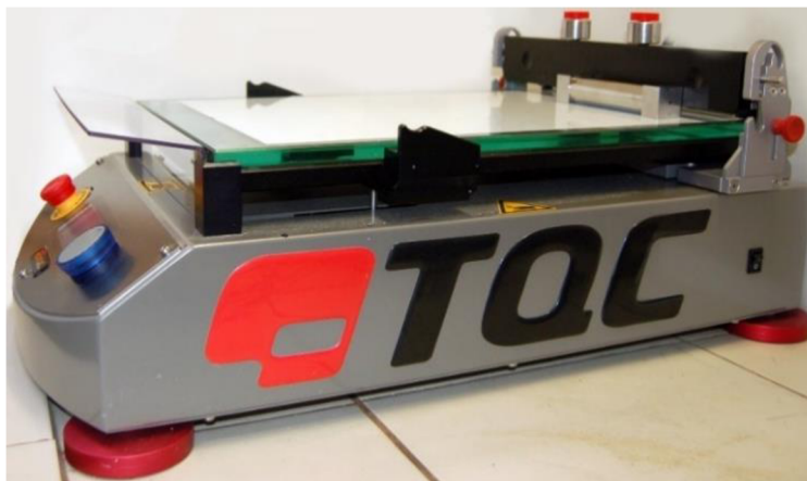
Obrázek 32 Automatický aplikátor filmu TQC s Bakerovým pravítkem
