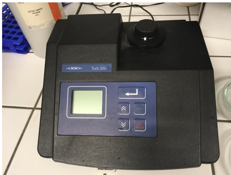
Obr. 9: Laboratorní turbidimetr WKW Turb 550.
