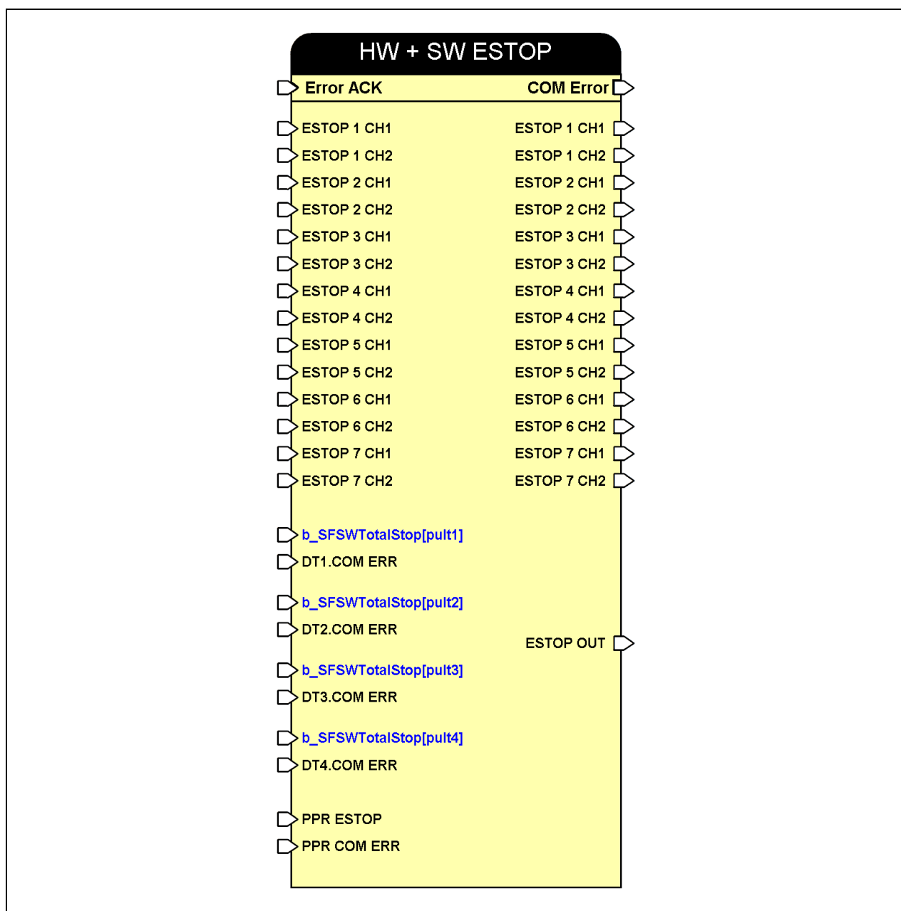
Obr. 40: Blokové schéma bezpečnostního PRG – funkční blok
