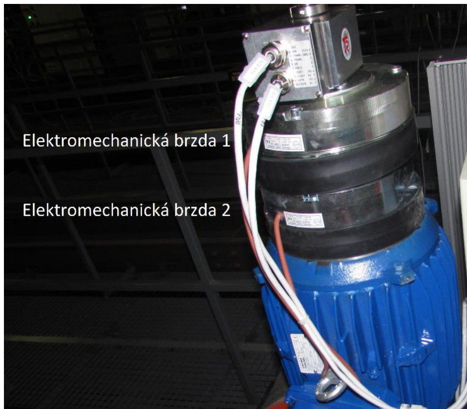
Obr. 28: Asynchronní elektromotor s dvojitou brzdou
