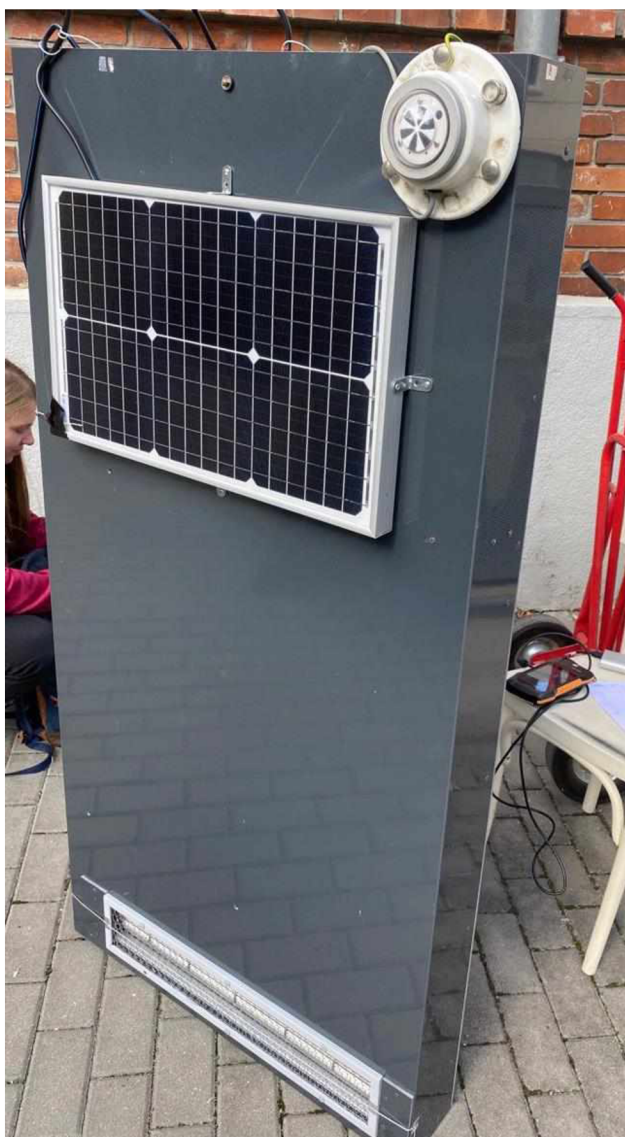
Obr. 14 Solární větrací systém
