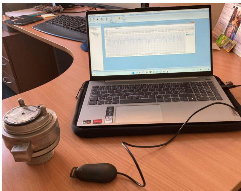
Obr. 1. 17 Programování tlakového čidla Sebalog P-3 pomocí programu Seba Data View
