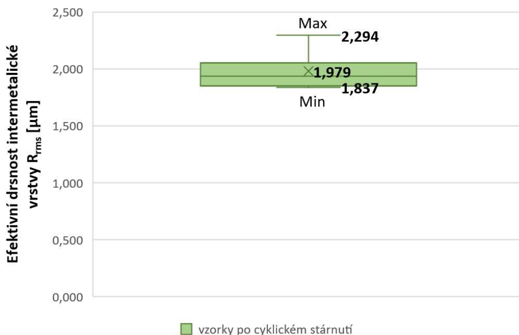
Graf 8: Statistické vyhodnocení efektivní drsnosti intermetalické vrstvy u cyklicky stárnutého vzorku
