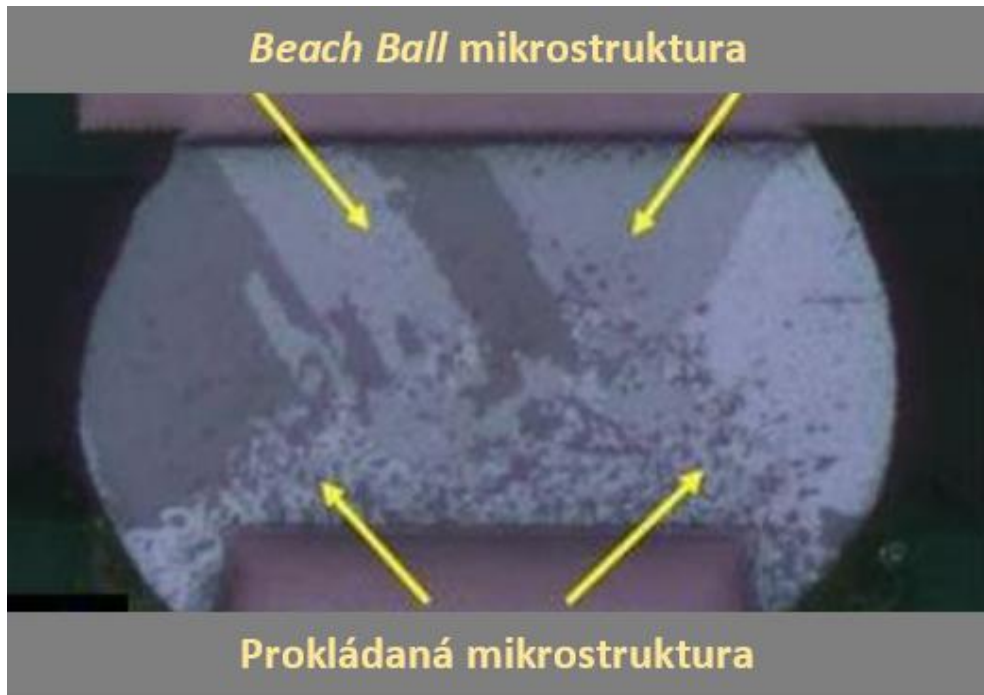
Obrázek 2: Morfológická struktura cínových dendritů Beach Ball a struktura prokládaná [9]
