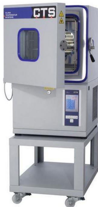
Obrázek 4: Klimatická teplotní komora CTS-T-40/25 [5]
