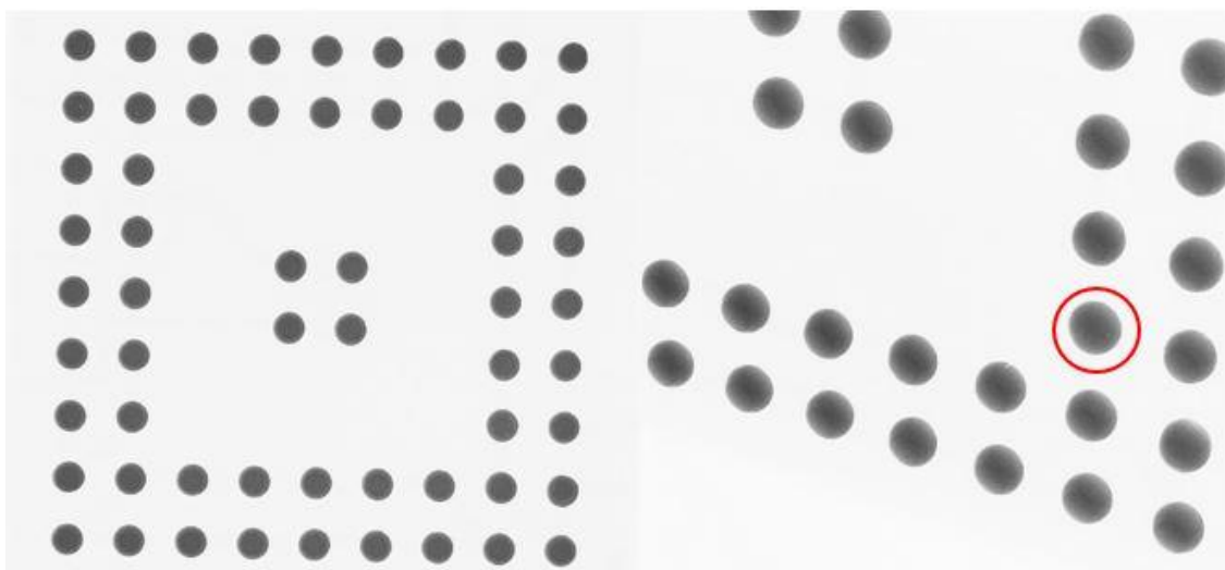
Obrázek 26: Rentgenová inspekce zapájeného BGA pouzdra 2 na zkušební DPS s identifikací nevodivého spoje (označeno červeně)
