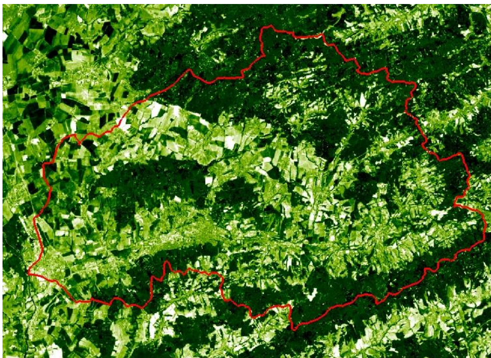
Obr. 11 Výpočet ND45. Na obrázku je možné vidět výstup ND45 s hranicí povodí Dřevnice (zdroj: vlastní zpracování).
