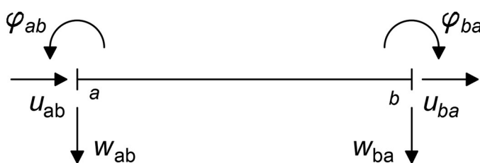
Obr. 2.5: Konvence parametrů deformací prutu ab
