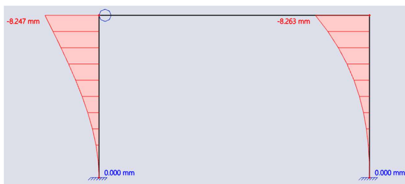
Obr. 5. 26: Vodorvný posun ve SCIA Engineer, příklad č. 4
