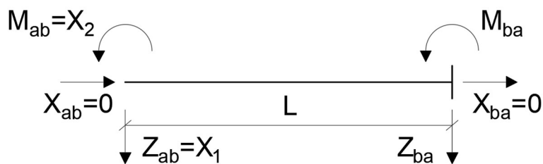
Obr. 4. 11: Základní soustava pro \varphi_{ab} , typ 111-111
