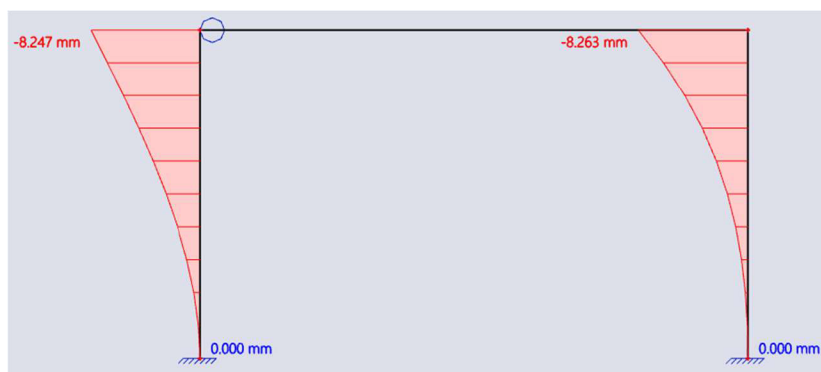
Obr. 5. 26: Vodorvný posun ve SCIA Engineer, příklad č. 4
