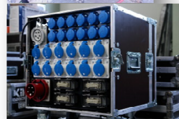
Obrázok 2.7: Výkonová jednotka LitePuter LX1220, ktorú som osadil a zapojil do caseu s istením a DMX splitterom
