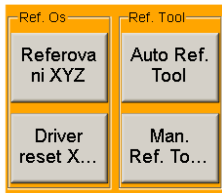
Obr. 47) Panely pro ovládání referování os a referování zásobníku nástrojů.
