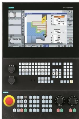
Obr. 21) Řídící panel Sinumerik 828D [24] [23]
