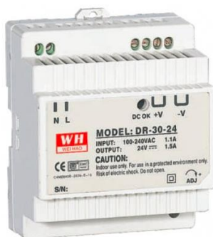
Obr. 37) Průmyslový spínaný napájecí zdroj na DIN lištu 30 W DR30. [35]
