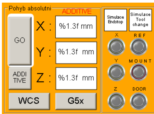
Obr. 45) Panel absolutního pohybu s tlačítky pro simulaci indukčních snímačů.
