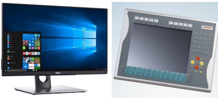
Obr. 40) Dotykový monitor DELL P2418HT (vlevo), kontrolní panel BECKHOFF CP79xx (vpravo). [38] [31]
