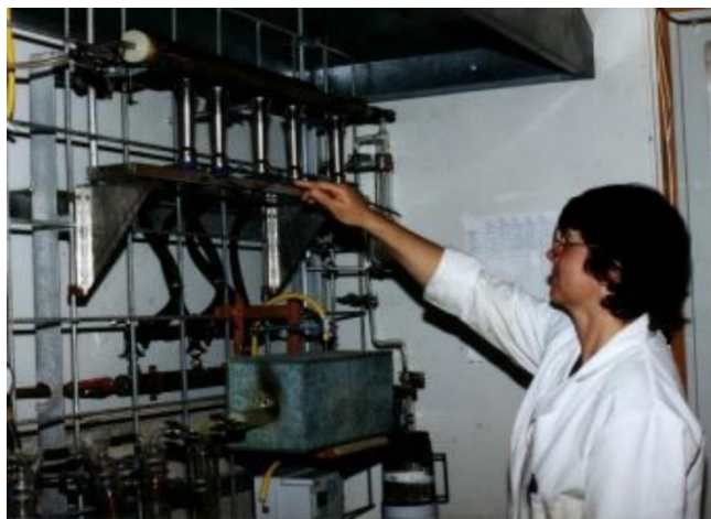
Obr. 14 - Spalovací systém připravující CO 2 z organického materiálu. [1]
