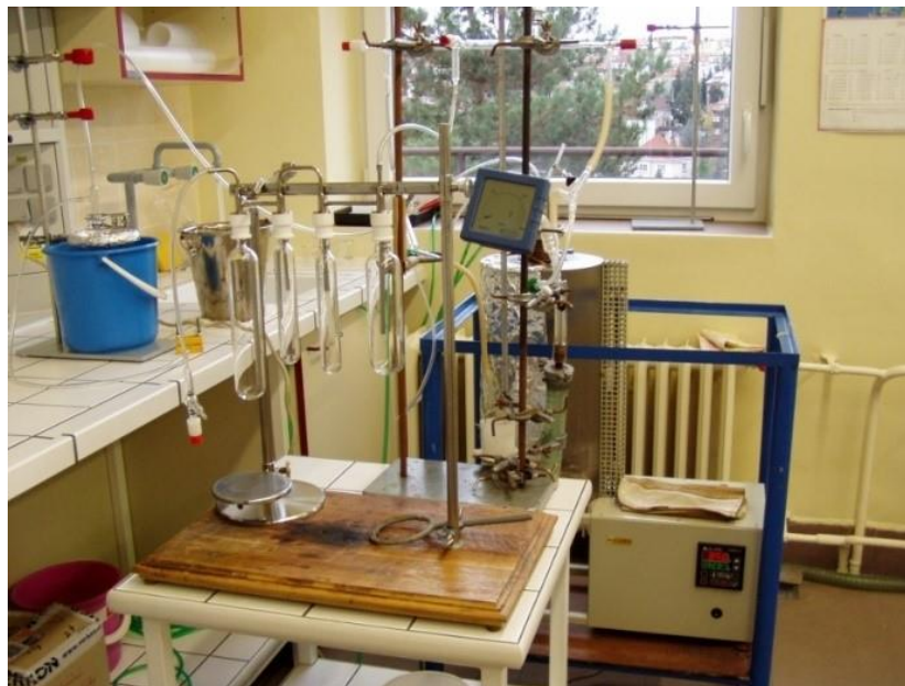
Obr. 12 - Převedení uhlíku do vhodné formy pro měření radioaktivního uhlíku (zde benzen). Aparatura v Oddělení dozimetrie ÚJF AVČR. [10]
