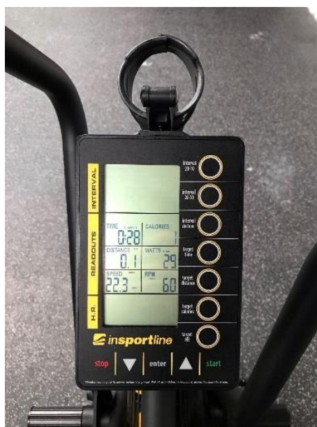
Obrázek 20: Beast AirBike – detail tachometru
