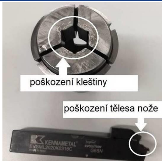
Obr. 33 Důsledek nastavení nedostatečného zbytku tyče polotovaru.
