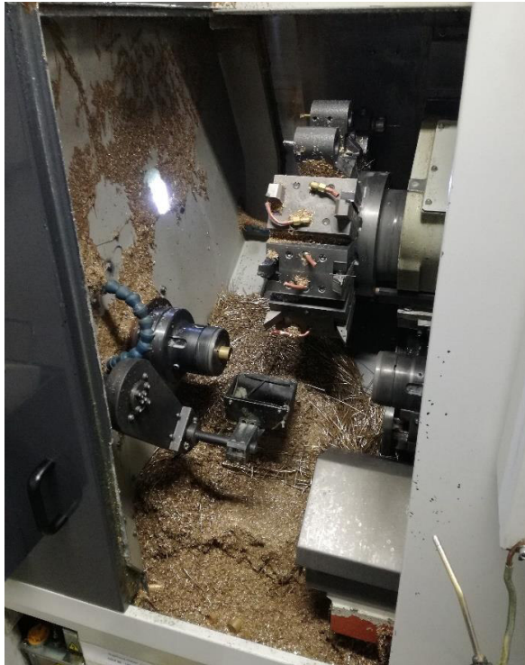
Obr. 6 Zanedbání odchodu třísek z pracovního prostoru CNC soustruhu (vypnutý pásový dopravník).
