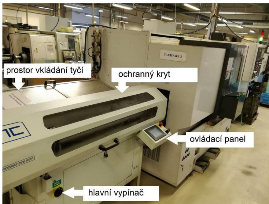
Obr. 34 Zásobník tyčového materiálu pro zvolený CNC soustruh.
