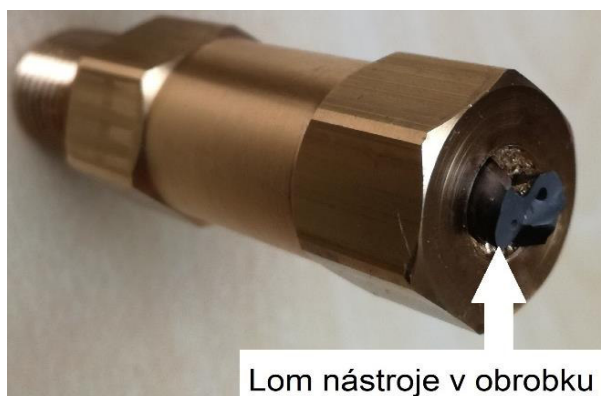
Obr. 60 Lom nástroje (šroubovitý vrták ze SK).
