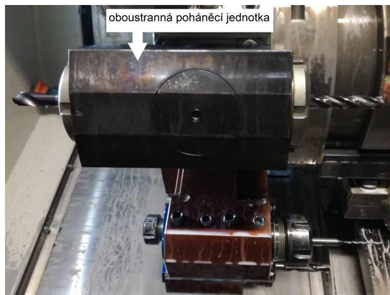
Obr. 40 Oboustranná poháněcí nástrojová jednotka (u varianty „C“).
