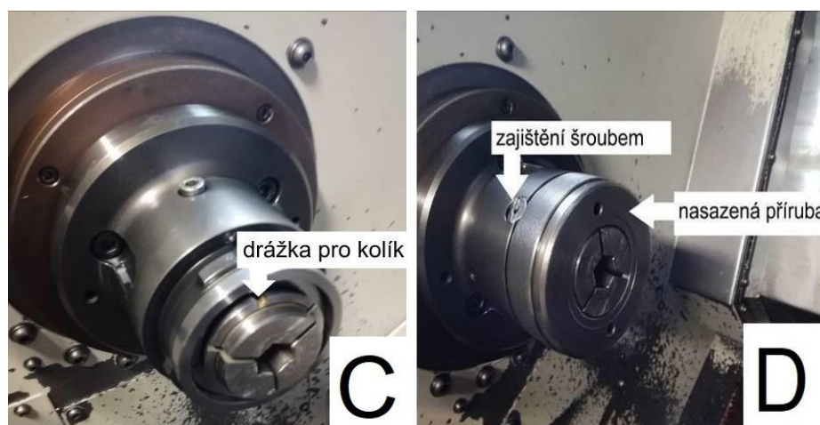
Obr. 30 Pohled na hlavní pracovní vřeteno zvoleného CNC soustruhu; C – vložení kleštiny, D – zajištění kleštiny ve vřetenu.
