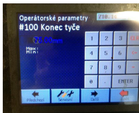
Obr. 32 Parametr podavače – zadání délky konce tyče.
