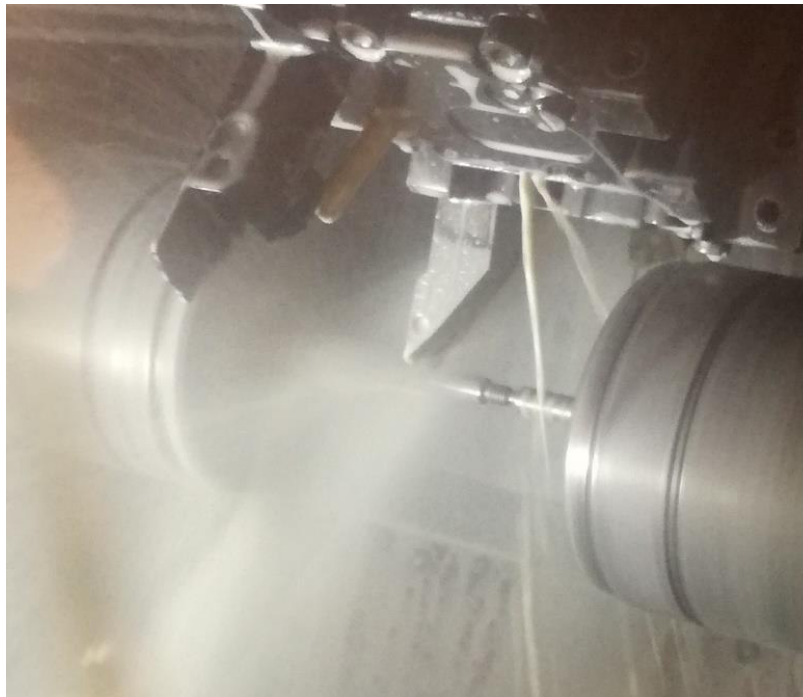
Obr. 16 Podepření dlouhého obrobku s vyžitím vedlejšího pracovního vřetena.
