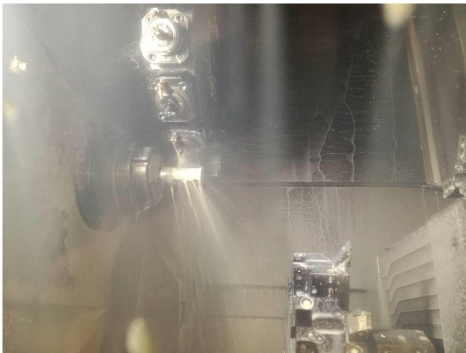
Obr. 2 Proces třískového obrábění na CNC soustruhu (frézování obrobku poháněcí jednotkou s využitím procesní kapaliny).
