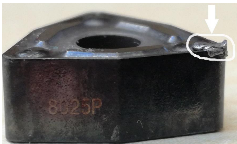
Obr. 4 Nárůstek (zvýrazněná oblast) na břitu vyměnitelné břitové destičky ze SK.
