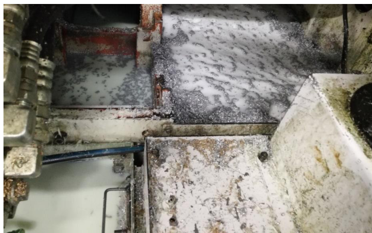
Obr. 62 Třísky naplavené v nádrži CNC soustruhu.
