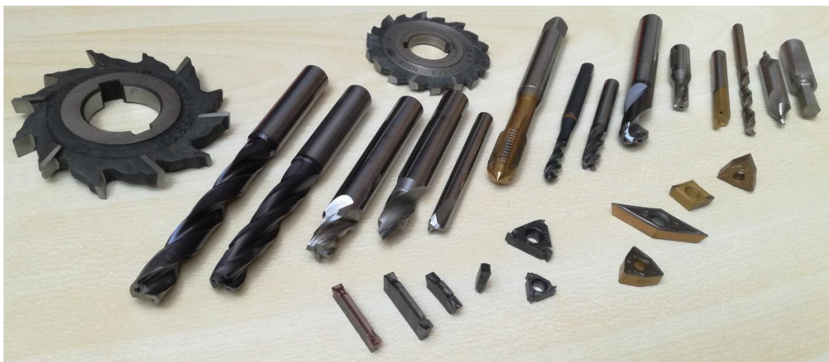
Obr. 10 Ukázka řezných nástrojů (frézy, VBD, šroubovité vrtáky a další) z HSS a SK.
