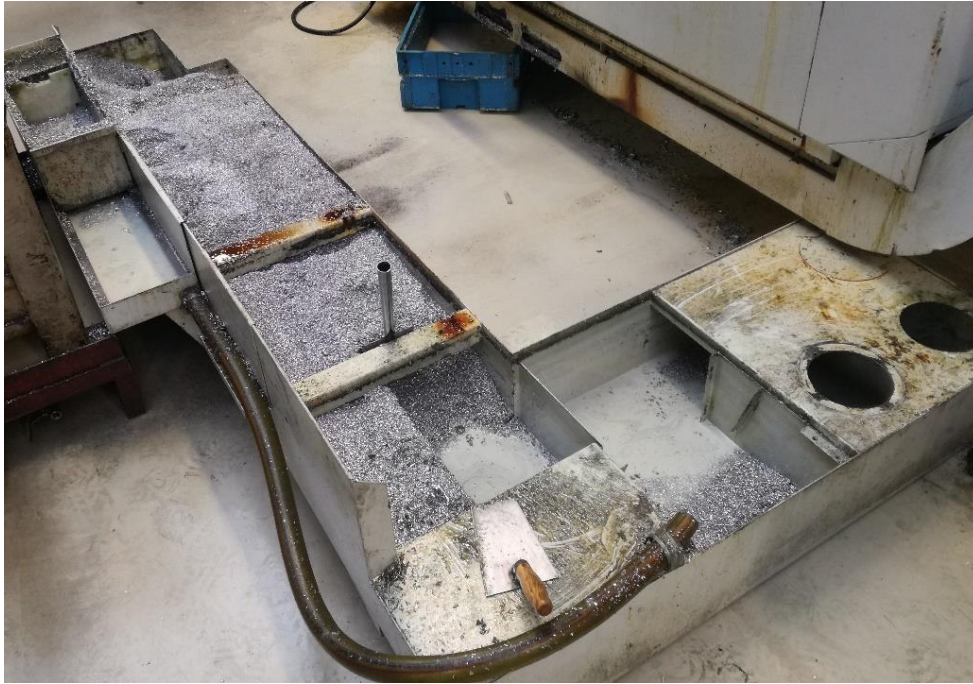
Obr. 15 Čištění nádrže CNC soustruhu od třísek.
