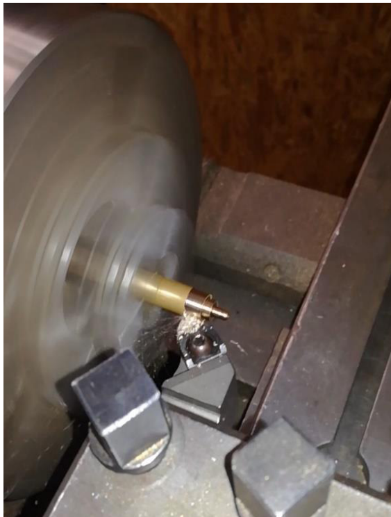
Obr. 3 Zachycení procesu řezání při soustružení (konvenční soustruh).
