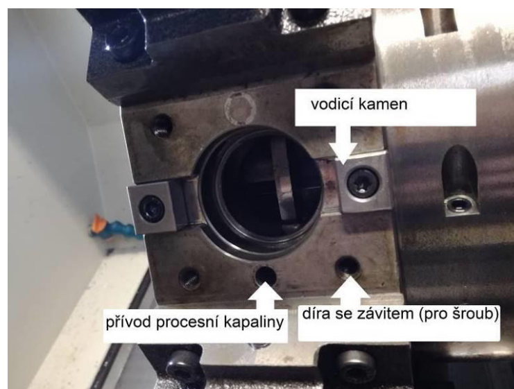
Obr. 38 Upínání segmentů k revolverové hlavě.
