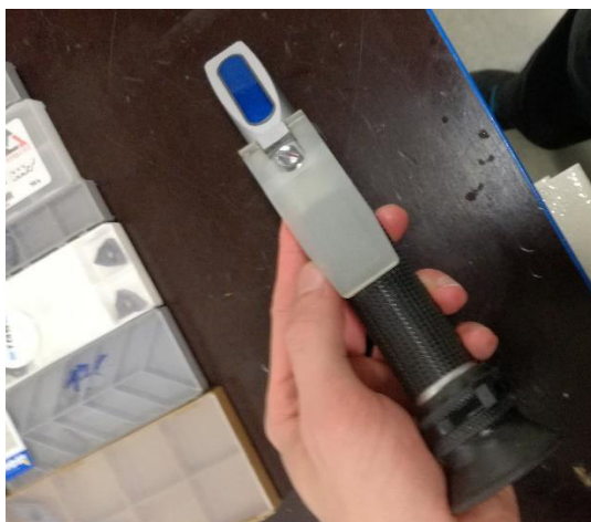
Obr. 41 Refraktometr pro měření koncentrace procesní kapaliny.
