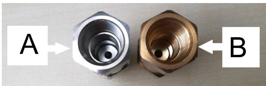
Obr. 61 Ukázka rozměrově stejného obrobku z různých materiálů; A – Obrobek z korozivzdorné oceli, B – totožný obrobek z mosazné slitiny.
