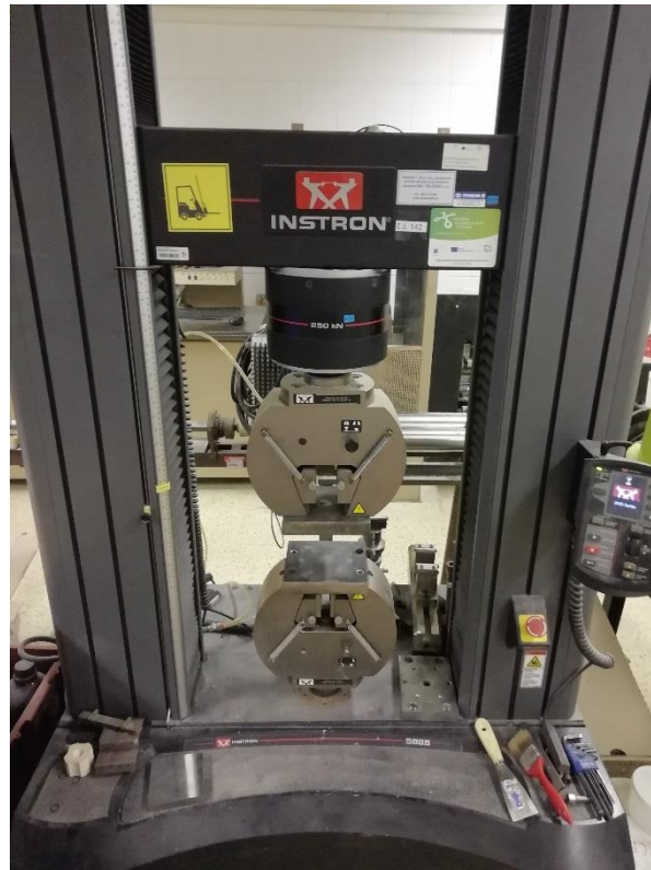
Obrázek 7: Univerzální testovací stroj Instron 5985 – přístroj pro měření pevností v tlaku a ohybu
