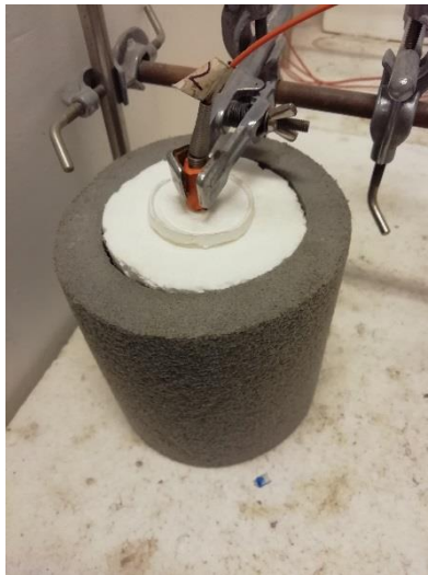
Obrázek 6: Detail termoizolační vrstvy s vloženou teplotní sondou kalorimetrické komory
