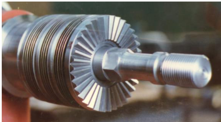
Obrázek 35 Rotor převodovky s Hirthovým ozubením a centrálním šroubem [12]
