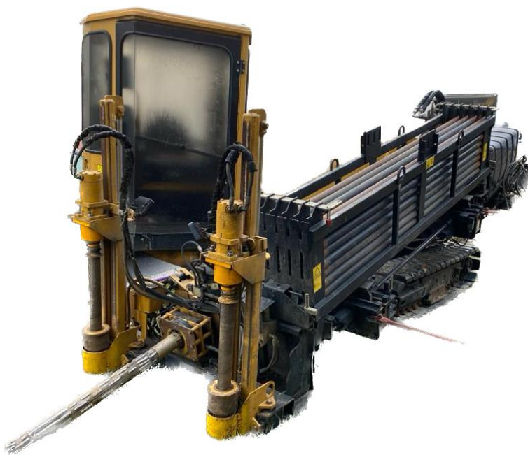
Obrázek 1: Vrtná souprava pro mikrotunelování (zdroj: Autor)
