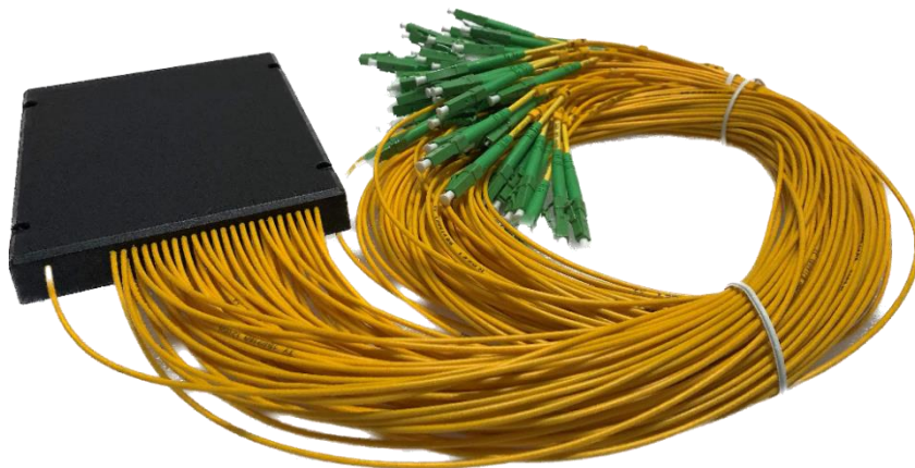
Obrázek 8: Optický splitter s odbočným poměrem 1:64 (zdroj: Autor)
