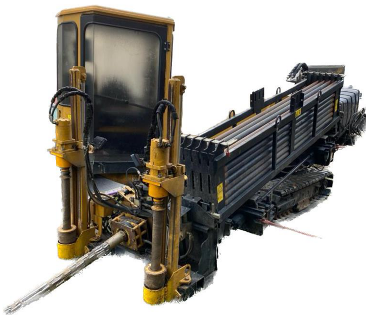
Obrázek 1: Vrtná souprava pro mikrotunelování (zdroj: Autor)
