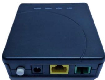
Obrázek 11: Jednotka ONT s portem RJ45 (žlutý) a optickým vstupem (zelený) (zdroj: Autor)
