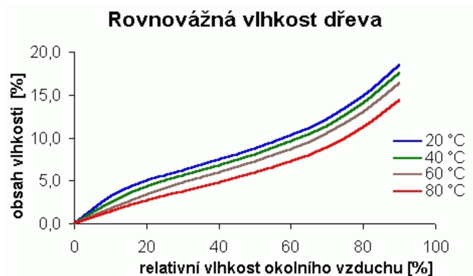
Obr. 2 Rovnovážná vlhkost dřeva v závislosti na teplotě a vlhkosti okolního vzduchu podle [24]
