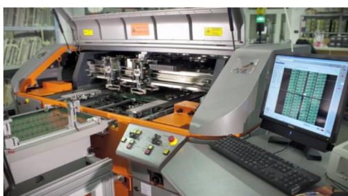
Obr. 26: ATG A-6 Flying probe tester (vlevo), rentgenový inspekční systém Phoenix Nanomex (vpravo)
