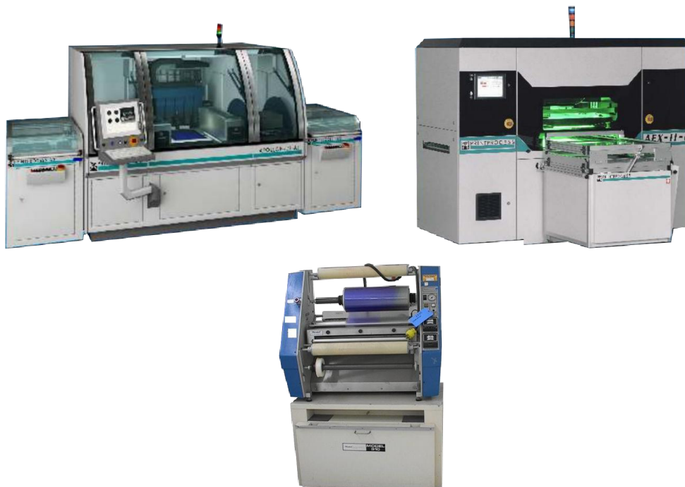
Obr. 21: Zařízení pro přímé zobrazování Apollon (vlevo nahoře), ozařovací zařízení Expomat AEX2 (vpravo nahoře) a laminovačka pro řezané tabule Dynachem (uprostřed dole)
