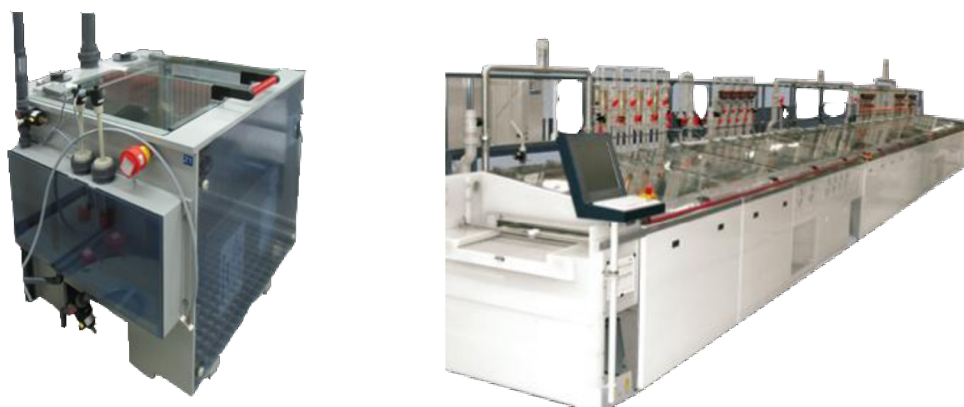
Obr. 19: Systém regenerace CCR Schmid (vlevo) a systém pro dezoxidaci Schmid (vpravo)
