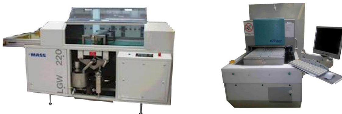
Obr. 23: Segment zařízení pro nanášení vrstev nepájivé masky MASS LGW 220 (vlevo), tiskárna servisního potisku Printar (vpravo)
