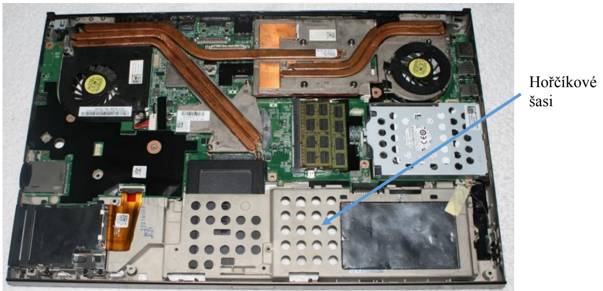
Obr. 12 Spodní díl šasi ze slitin hořčíku a hliníku s komponentami
