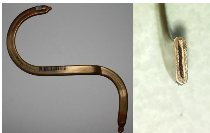
Obr. 6 Heatpipe (vlevo) a struktura vnitřní stěny trubičky (vpravo)
