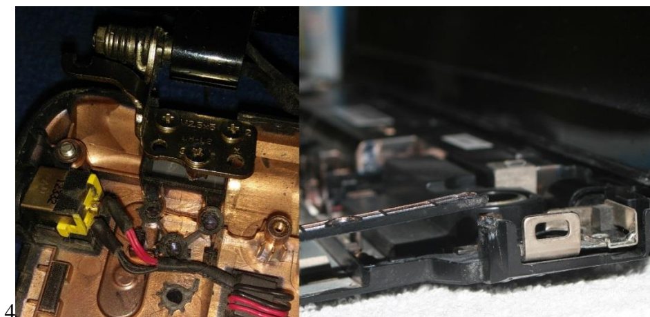
Obr. 15 Vady vzniklé únavou materiálu u přichycení pantu (vlevo) a namáhání u pantu (vpravo)
