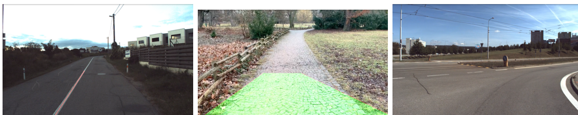
Obr. 2.12: Neúspěšná detekce. Zleva: (1) Jízda s nedostatečným okrajem na pravé straně (2) Parková cesta s příliš mnoha hranami v obraze (3) Jízda do ostré zatáčky s nedostatečným okrajem
