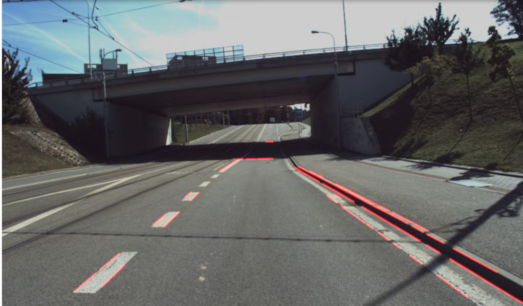
Obr. 2.8: Obraz s nalezenými čarami po Houghově transformaci
