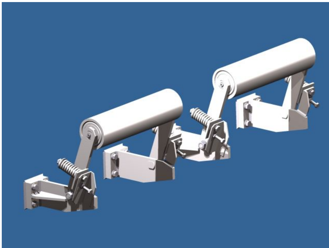
Obr. 3.7: Návrh přitlačování lan
