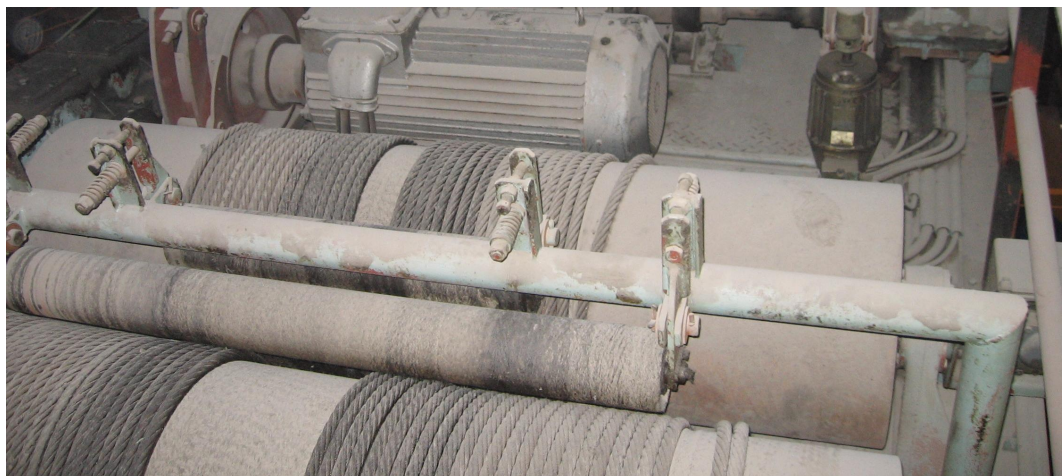
Obr. 2.5: Původní konstrukce lanových bubnů
