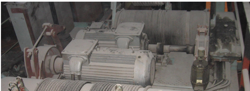
Obr. 2.3: Původní pohony hlavního a pomocného zdvihu
