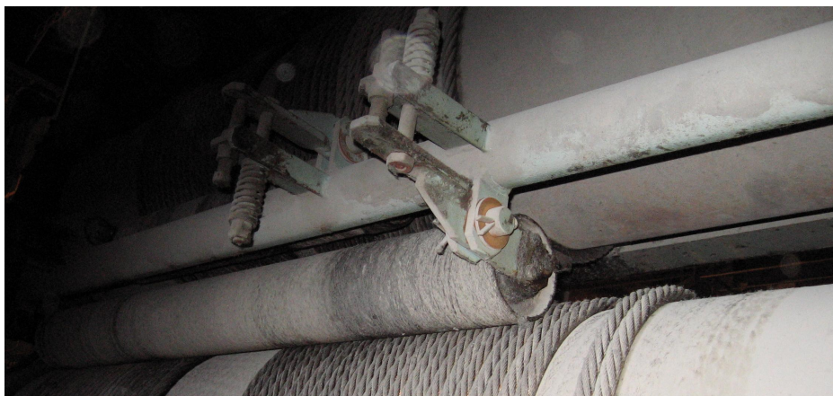
Obr. 2.7: Původní konstrukce přitlačování lan
