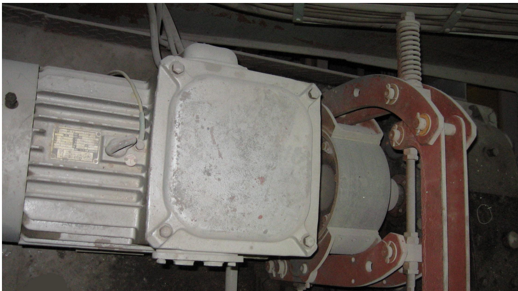
Obr. 2.2: Původní pohon pojezdu mostu
