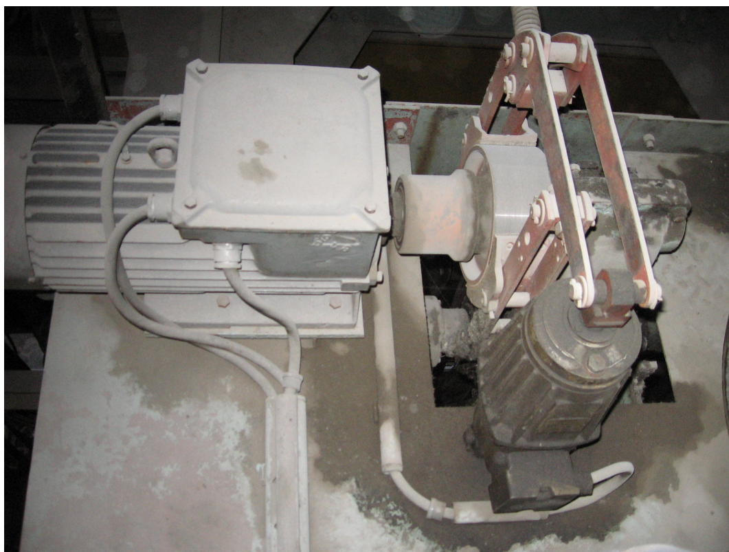
Obr. 2.1: Původní pohon pojezdu kočky
