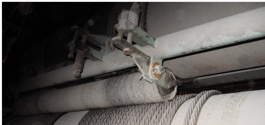
Obr. 2.7: Původní konstrukce přitlačování lan
