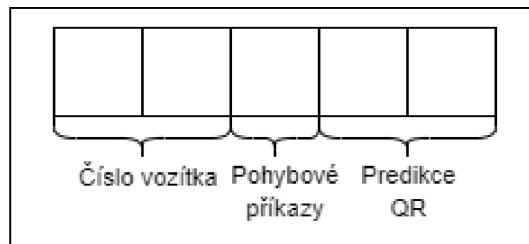
Obrázek 3.13 Struktura paketu odesílané zprávy
