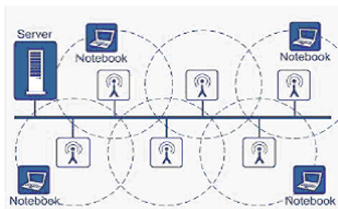
Obrázek 3.7 Struktura bezdrátové sítě – Infrastrukturní síť [24]
