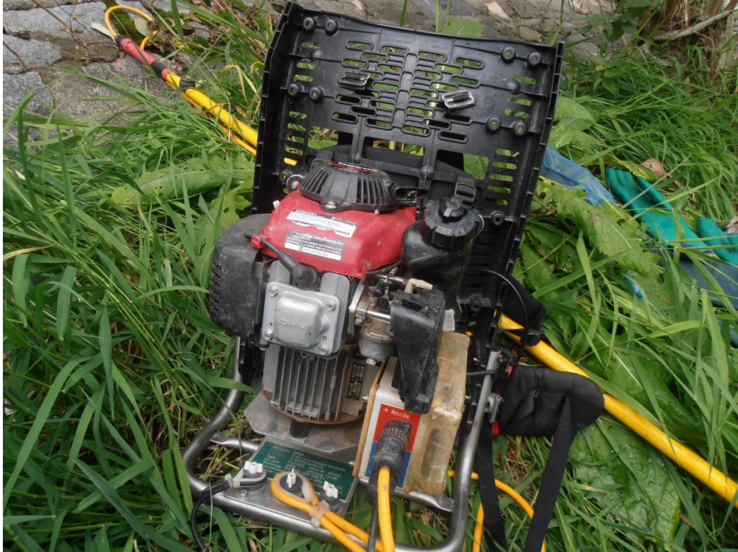
Příloha 1 Elektrický agregát k odlovu ryb (Foto: autor)
