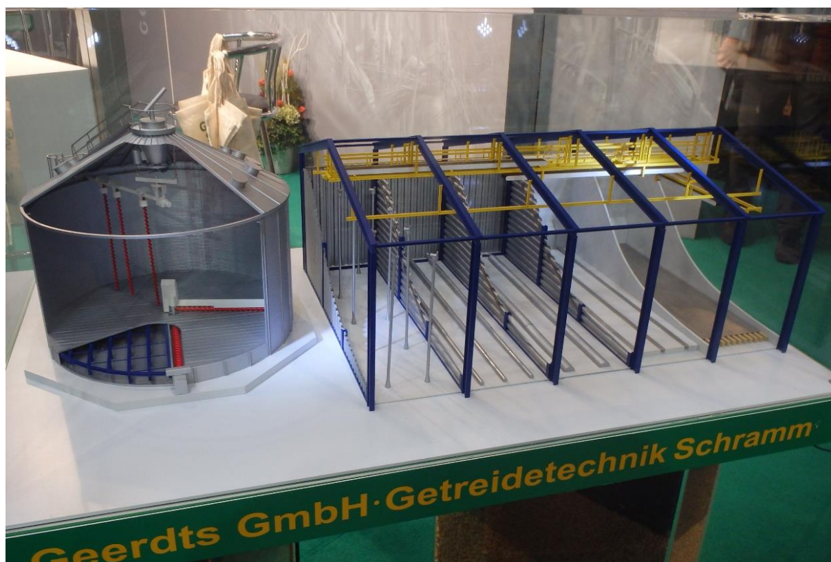
Zleva: Silo – provzdušňovací jehly; celoprovzdušněná podlaha Hala – jehly; nadúrovňové kanály; podúrovňové kanály; celoprovzdušněná podlaha.
