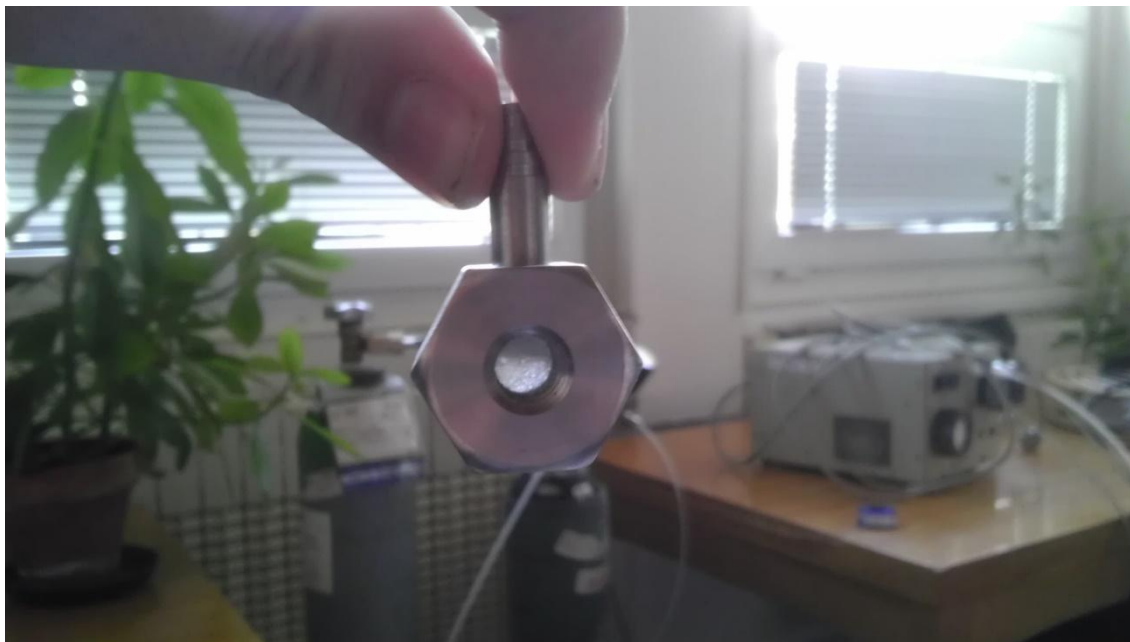
Obrázek 43: Lis s vylisovanou tabletkou mikrokrystalické celulózy s bromidem draselným
