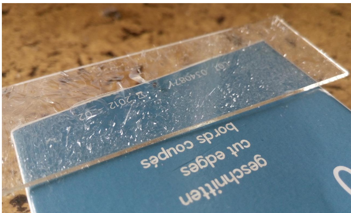
Obrázek 25: Odlupující vrstva na vzorku č. 2 (90 Pa, kyslík + HMDSO 250 sccm, 12,9 cm, 500 W, 30 minut)
