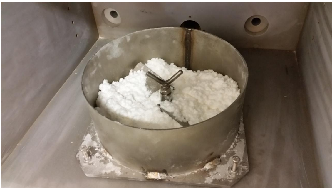
Obrázek 15: "Velká míchačka" připravená pro experiment s celulózou
