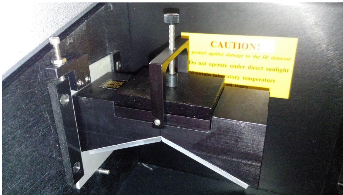
Obrázek 42: Příslušenství pro metodu ATR s již umístěným vzorkem
