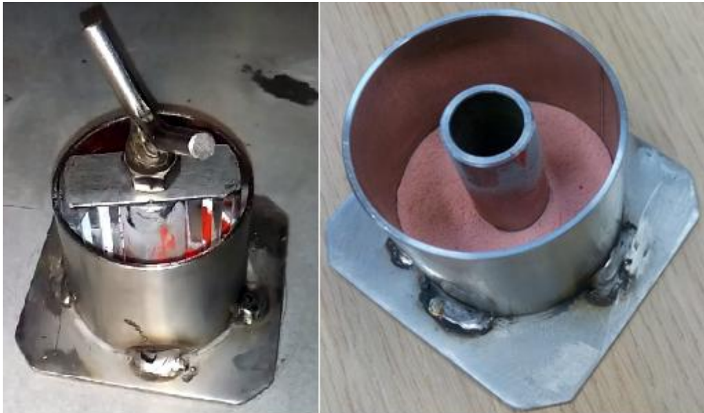
Obrázek 14: Mikrokrystalická celulóza s barvivem Acid Orange II před a po míchání
