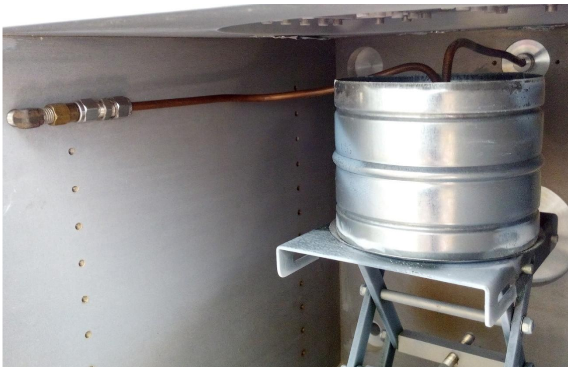
Obrázek 16: Dvojice trubiček přivádějící pracovní plyn a výpary prekursoru z výparníku do nádoby se substrátem
