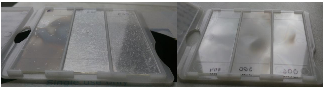
Obrázek 28: Tenké vrstvy vzniklé u vzorků 1 – 6 (zleva)
