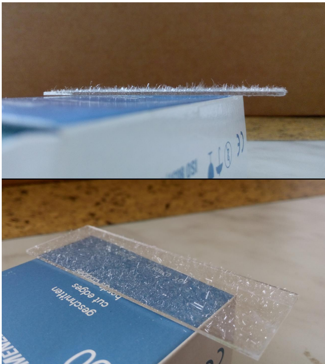
Obrázek 24: Pohled z boku a shora na vzniklou vrstvu na vzorku č. 3 (100 Pa, kyslíku + HMDSO 250 scem, 12,9 cm, 500 W, 29 minut)
