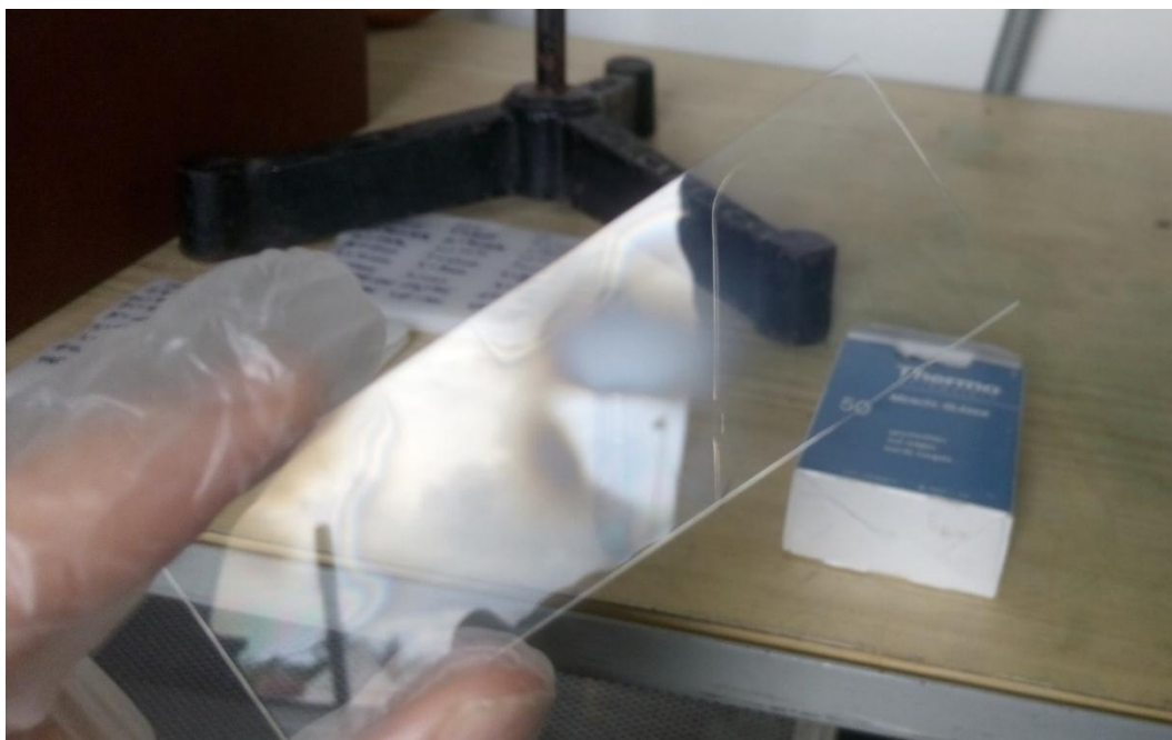
Obrázek 23: Vzniklá vrstva na vzorku č. 5 (170 Pa, kyslík + HMDSO 250 scem, 15 cm, 500 W, 10 minut)
