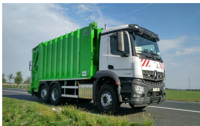
Obrázek 14. Fotografie svozového auta s lineárním stlačováním
