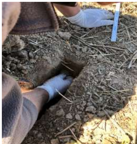
Obr. 2 Instalace senzorů do půdy
