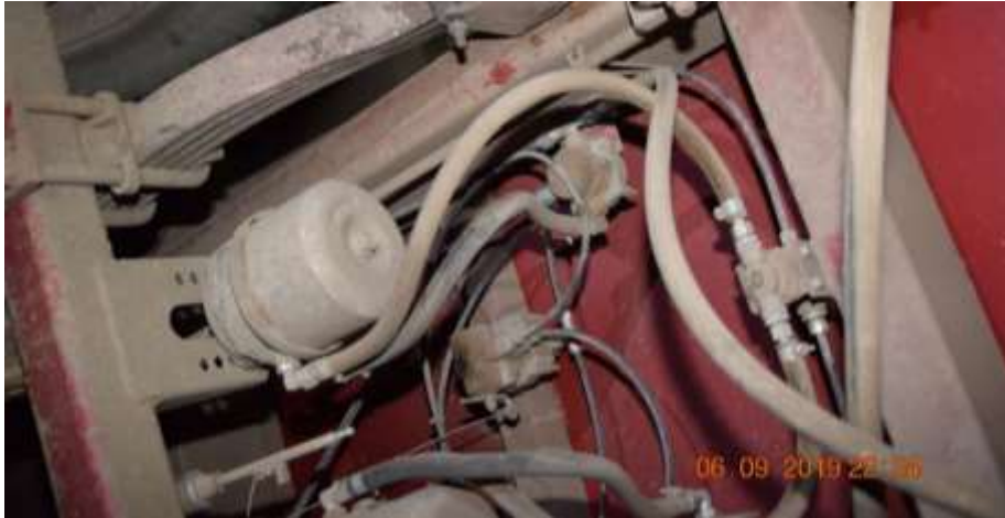
Obr. 52 Pohled na lanko AZR , které již není zapojené na tyče, snímek byl pořízen také při dokumentování dopravní nehody téměř ve stejné době jako předchozí snímek (zdroj: autor)
