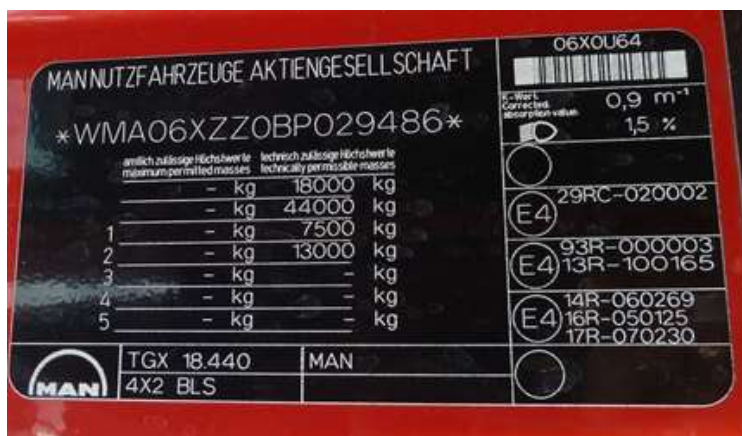
Obr. 69 Identifikační parametry tahače MAN TGX uvedené na štítku vozidla (zdroj: autor)
