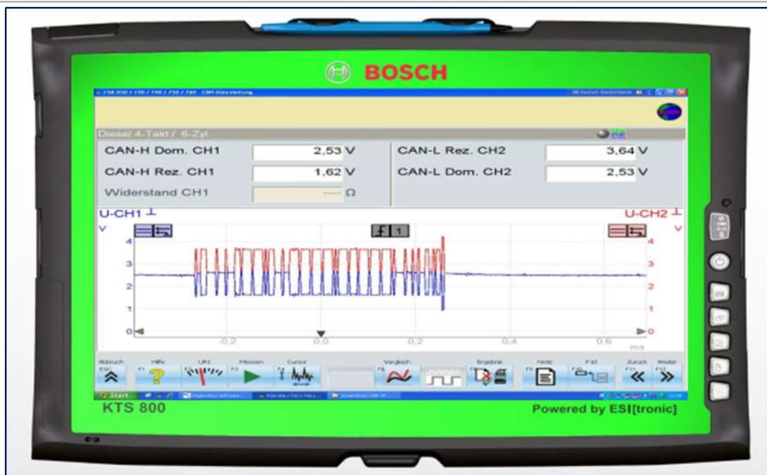
Obr. 5 Příklad měření signálu CAN pomocí osciloskopu (zdroj: archiv autora)
