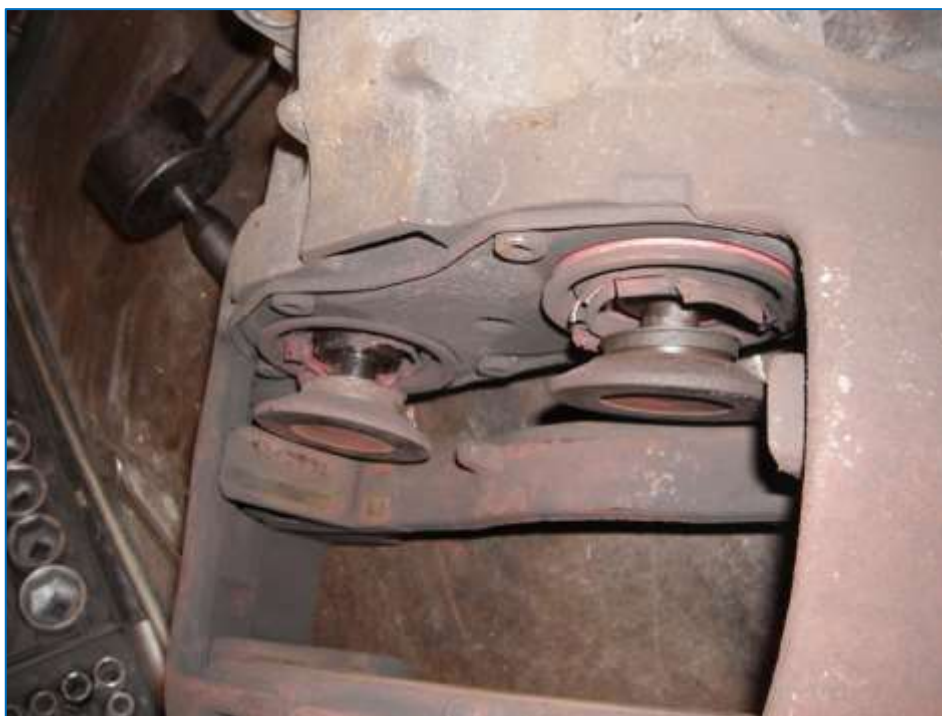
Obr. 15 Ukázka třmenu, který je nefunkční a v důsledku tohoto stavu je jednotka kolové brzdy nefunkční (Zdroj:archiv autora)
