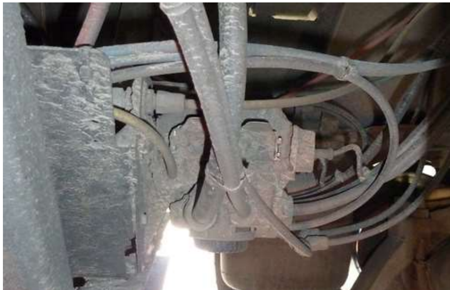
Obr. 61 Pohled na modulátor TEBS, kde je viditelná přerušená kabeláž (zdroj: autor)
