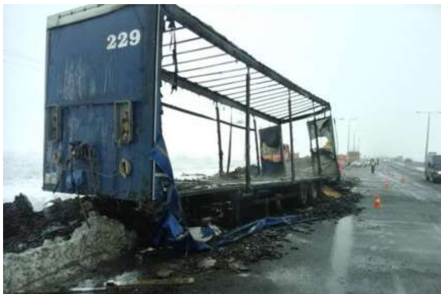
Obr. 54 Pohled na návěs, který byl zničen požárem v důsledku technické závady modulátoru TEBS (zdroj: autor)
