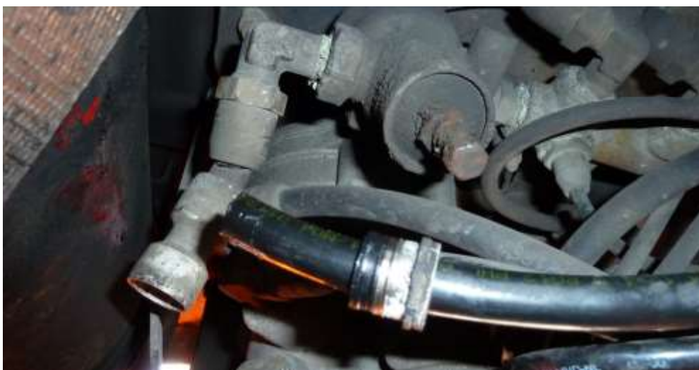
Obr. 60 Detailní zobrazení poškozeného pneumatického přípoje řídicího ventilu přívěsu (zdroj: autor)
