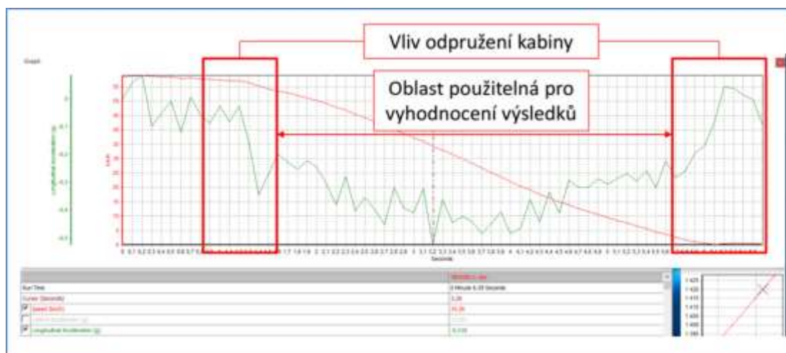
Obr. 27 Ukázka charakteristického průběhu měření s vyznačením oblasti vlivu odpružení kabiny a oblasti použitelné pro vyhodnocení výsledků (zdroj: autor)
