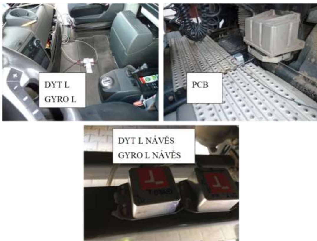
Obr. 35 Zobrazení snímačů a jejich umístění na tahači a na návěsu (zdroj: ÚSI, autor)
