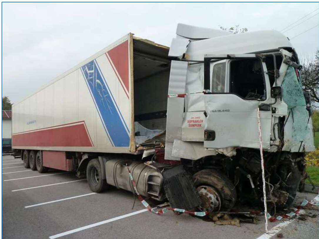
Obr. 20 Příklad jízdní soupravy, u které bylo i vzhledem k rozsáhlému poškození možné provést diagnostiku pomocí multiznačkového diagnostického zařízení (zdroj: archiv autora)
