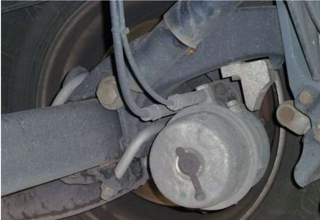
Obr. 82 Pohled na stav brzdového válce a třmenu návěsu (zdroj: autor)
