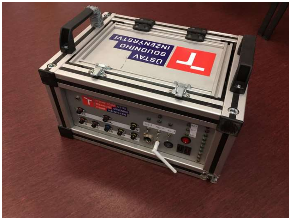
Obr. 33 Pohled na záznamové zařízení ÚSI RIO (zdroj: ÚSI, autor)
