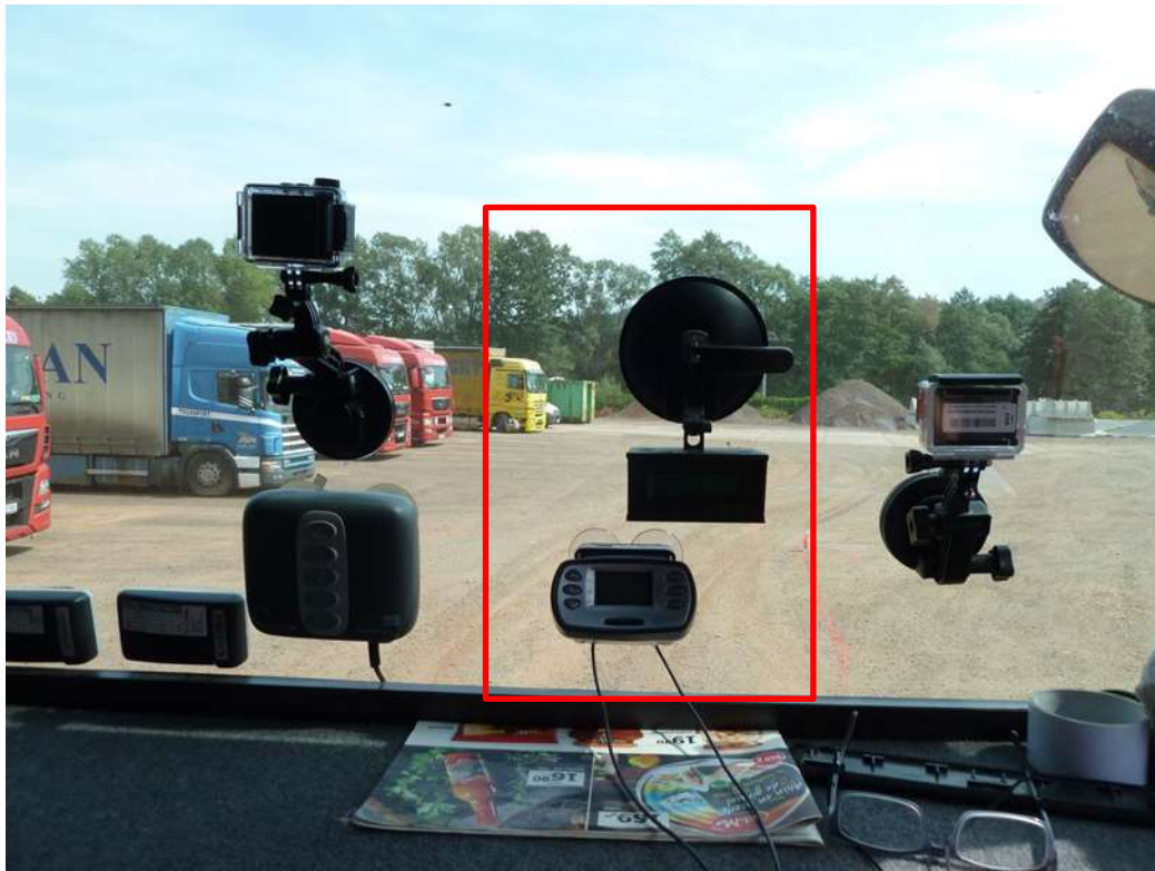
Obr. 30 Umístění měřících zařízení XL Meter a Racelogic na čelním skle tahače (zdroj: autor)
