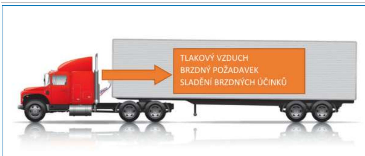
Obr. 6 Základní schéma komunikace brzdových soustav tažného a přípojného vozidla (zdroj: archiv autora)
