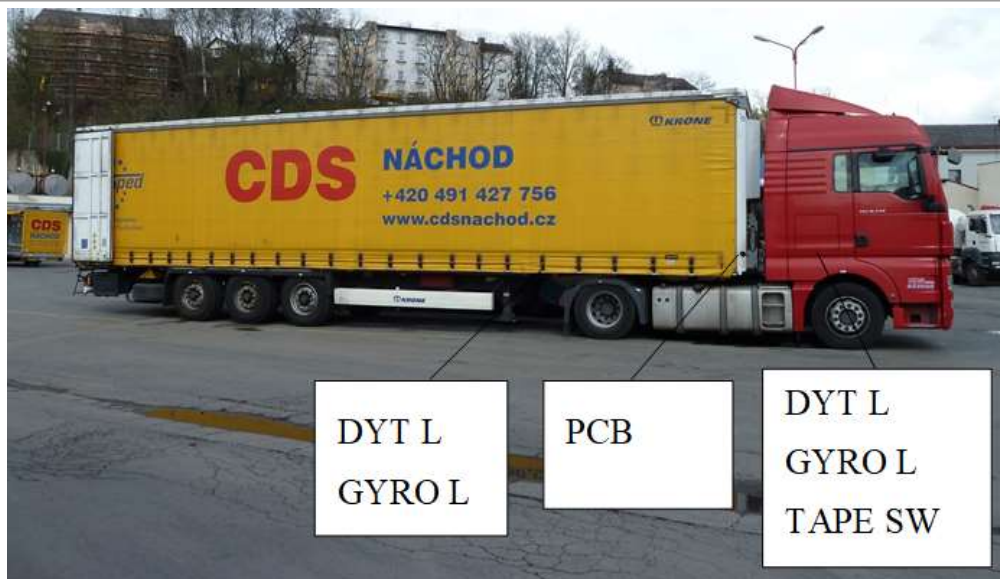
Obr. 34 Umístění snímačů na jízdní spoupravě (zdroj: ÚSI, autor)
