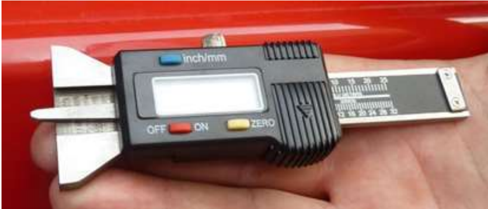
Obr. 80 Měření hloubky dezénu (zdroj: autor)
