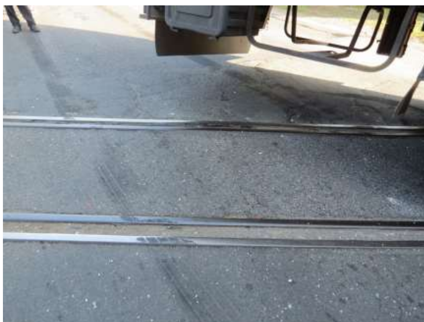
Obr. 55 Detailní zobrazení stop, které vznikly v důsledku odvzdušnění pružinových částí kombinovaných brzdových válců
