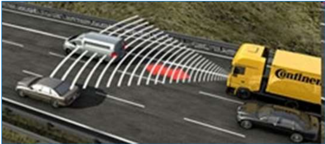
Obr. 11 Zobrazení funkce ACC – oblast snímání signálů a regulace (zdroj: archiv autora)
