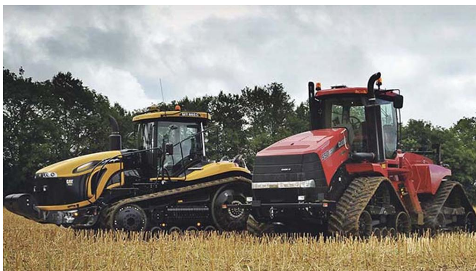
obr. 4 Traktor s dlouhými pásy, každý na jedné straně (vlevo) a traktor se systémem Quad-traks, nahrazujícím všechny čtyři kola (vpravo) (Zdroj: www.fginsight.com )
