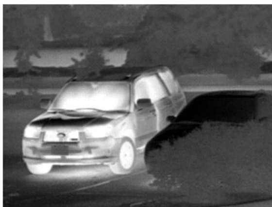
obr. 8 Termální snímek pořízený polem bolometrů s rozlišením 240 x 80 bodů (termální kamera FLIR Scout TS24) [12]
