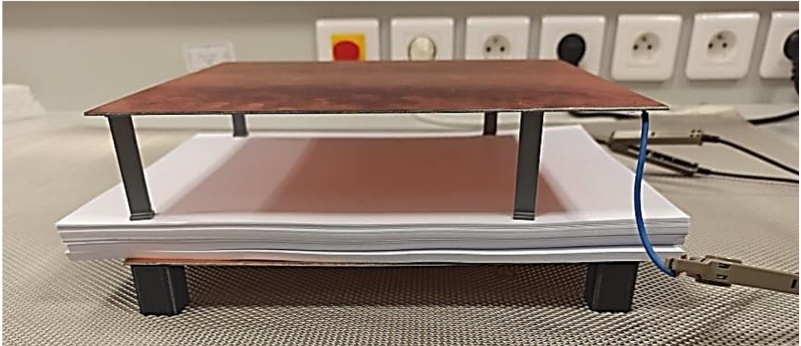
Obrázek 27 Experimentální část s dvěma dielektriky
